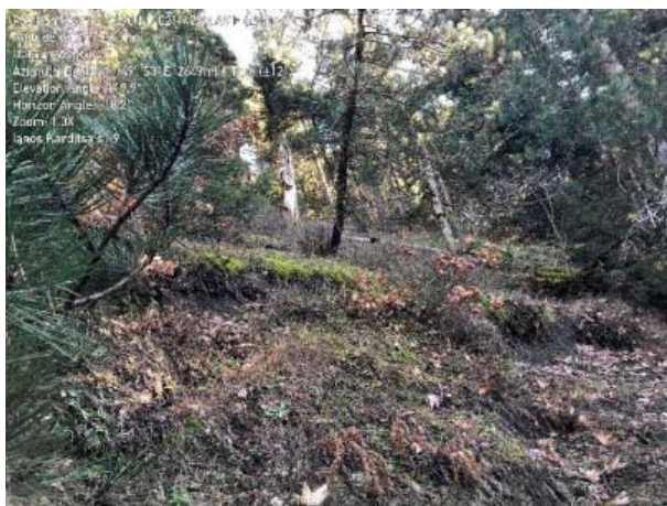
(γ) Εδαφικές θραύσεις, διαμόρφωση βαθμίδων, παραμόρφωση κορμών δέντρων, επιφανειακή διάβρωση και ερπυσμοί (Φωτ. Α. Γεωργαλάς, 2021)
