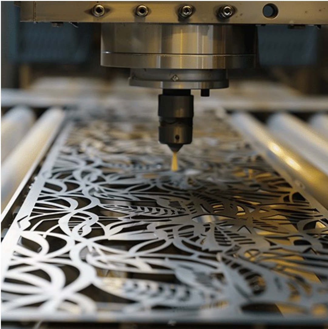
Εικόνα 1. Κοπή πάνελ αλουμινίου με λείζερ για διακοσμητική χρήση (Emery Laser, 2024)
