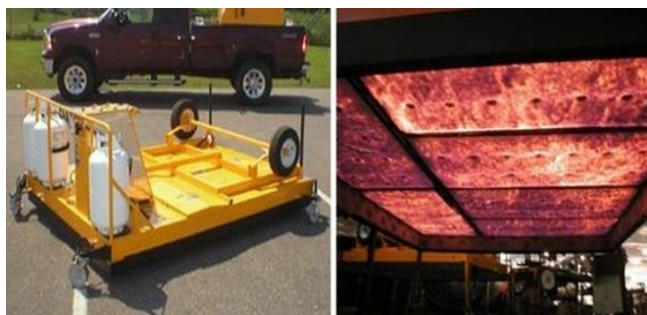
Εικόνα 24: Εξοπλισμός μεθόδου θέρμανσης μέσω μικροκυμάτων και δίπλα η λειτουργία του.
