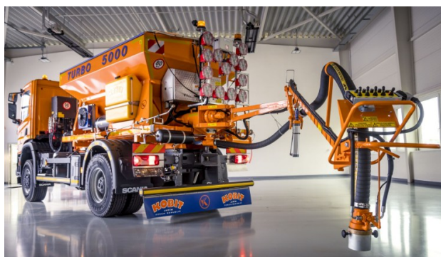
Εικόνα 37: Αυτοκινούμενο μηχάνημα (Road Patcher).
