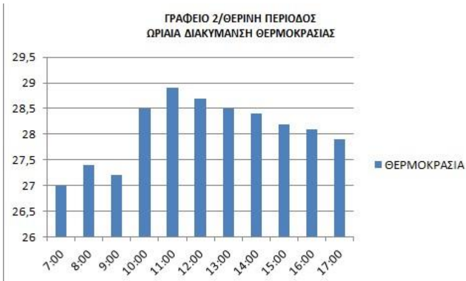
Εικόνα 1-23: Γράφημα μεταβολής θερμοκρασίας Γραφείου 2, κατά τη διάρκεια των εργάσιμων ωρών της 11ης Αυγούστου.
