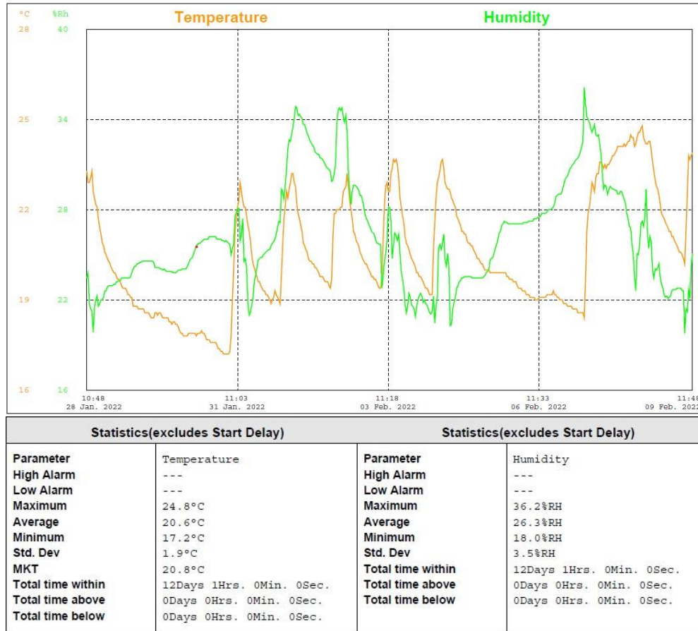
Εικόνα 1-10: Διάγραμμα τιμών εσωτερικής θερμοκρασίας και υγρασίας κατά τη χειμερινή περίοδο μελέτης του κτιρίου/ Γραφείο 1
