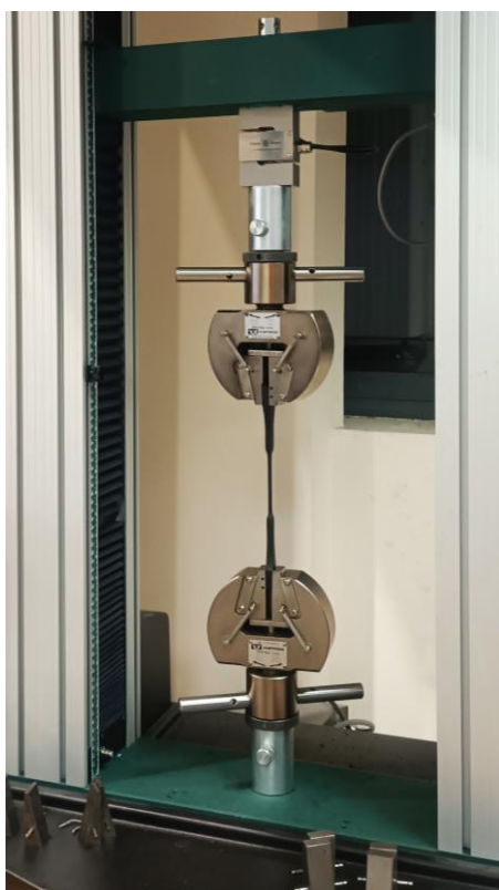
Εικόνα 5.4. Δοκίμιο σωλήνα σε διάταξη εφελκυσμού.
