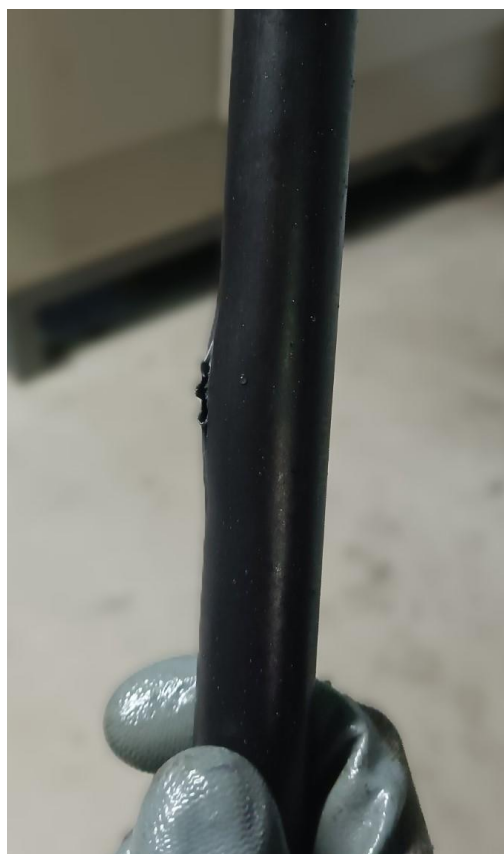
Εικόνα 5.2. Δοκίμιο σωλήνα που υπέστη θραύση.
