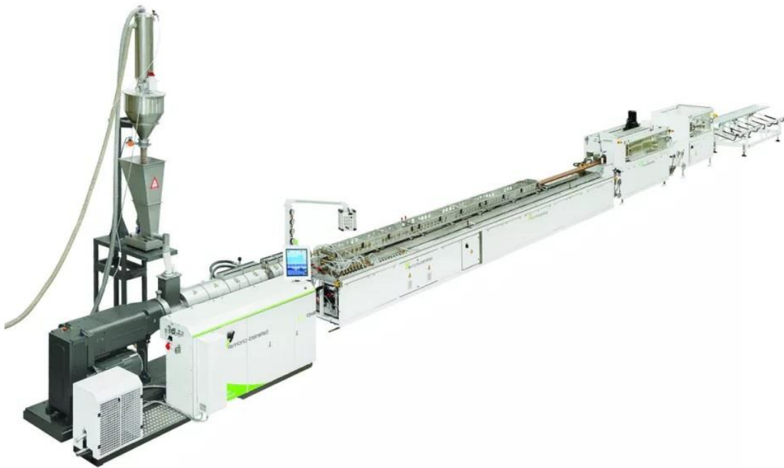
Σχήμα 5.1. Διάταξη μηχανής παραγωγής σωλήνα. Πηγή: www.battenfeld-cincinnati.com
