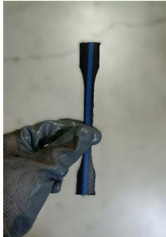
Εικόνα 5.3. Διάταξη μηχανής CNC και αποτέλεσμα του κοψίματος σωλήνα σε μορφή «κλεψύδρας».
