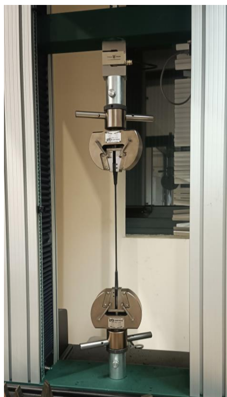
Εικόνα 5.4. Δοκίμιο σωλήνα σε διάταξη εφελκυσμού.
