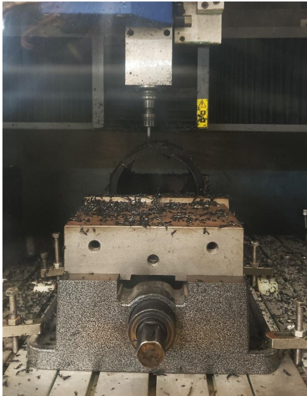
Εικόνα 5.3. Διάταξη μηχανής CNC και αποτέλεσμα του κοψίματος σωλήνα σε μορφή «κλεψύδρας».
