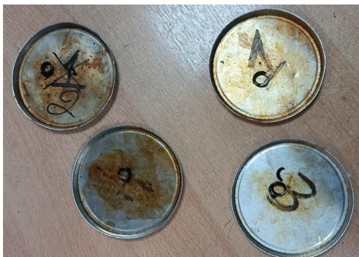
Εικόνα 5.7. Δοκίμιο σωλήνα σε ειδικά πιατάκια μετά το πέρας των 3 ωρών σε φούρνο στους 140°C.
