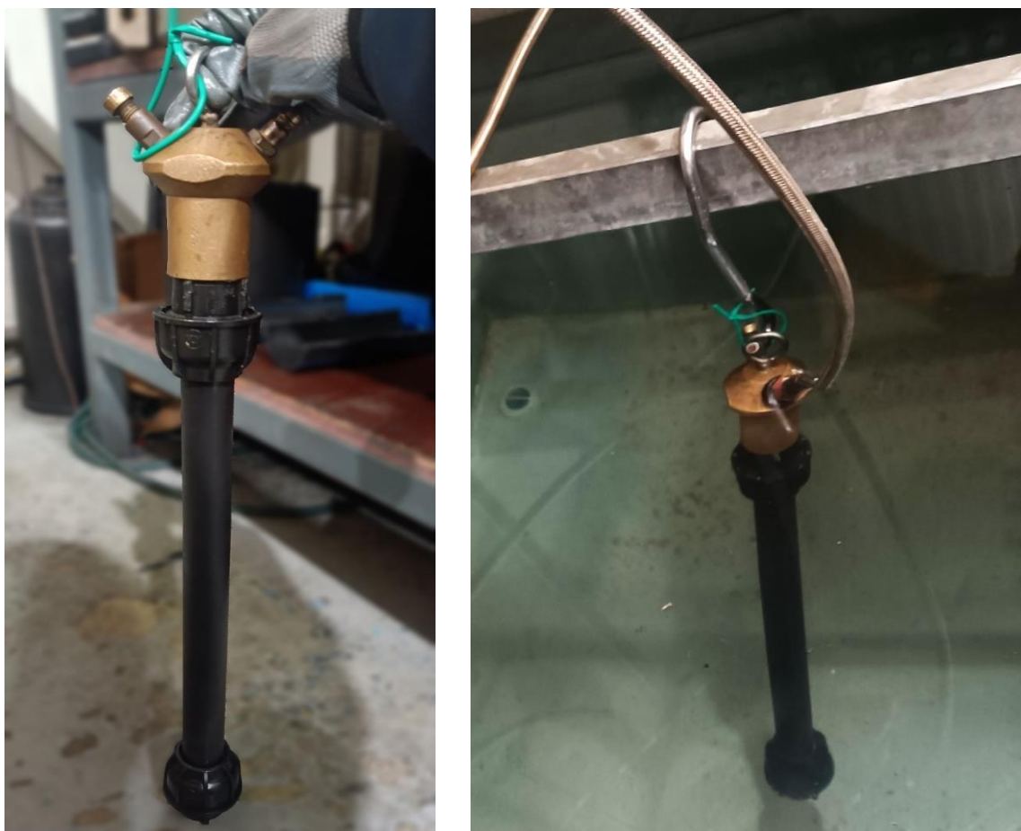
Εικόνα 5.1. Δοκίμιο σωλήνα έτοιμο για Ε.Υ.Π. (αριστερή εικόνα), δοκίμιο σωλήνα μέσα στην δεξαμενή (δεξιά εικόνα).
