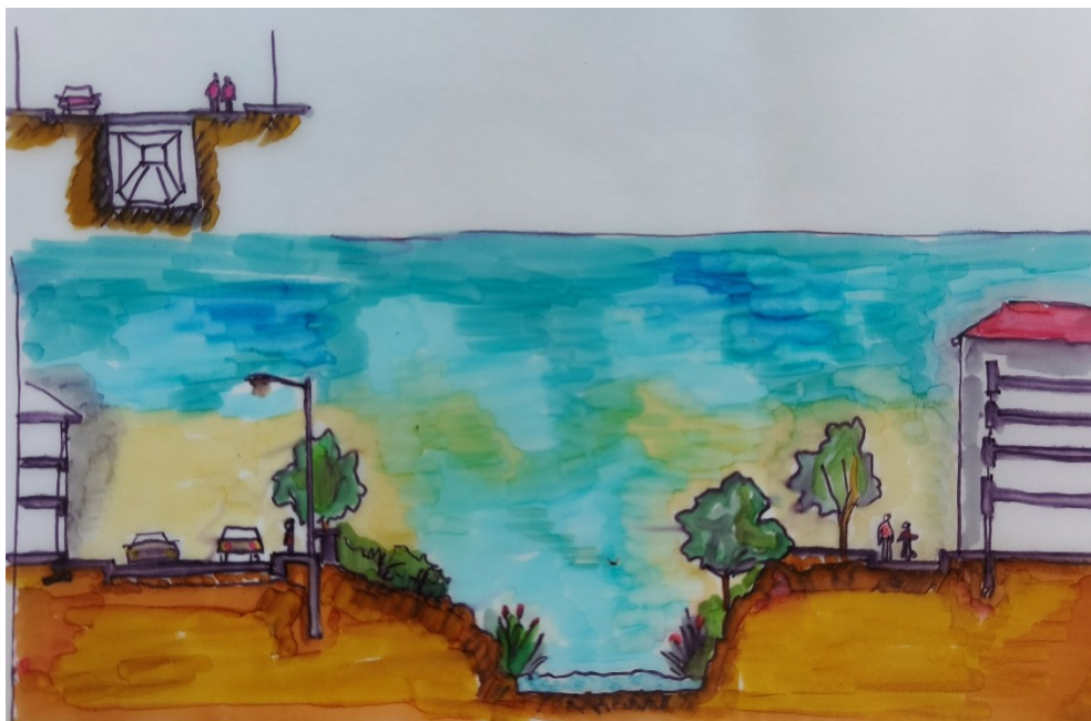
Εικόνα 125. Σχηματική τομή πρότασης απομάκρυνσης του εγκιβωτισμένου οχετού στη Θέση 2. Ιδία επεξεργασία.
