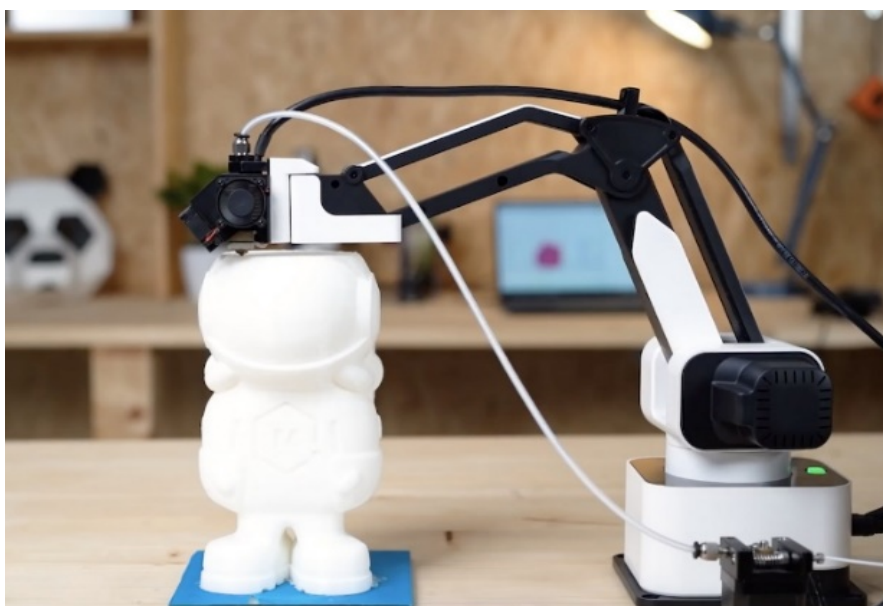
Εικόνα 6: Ρομπωτικός βραχίονας ως 3d printer
