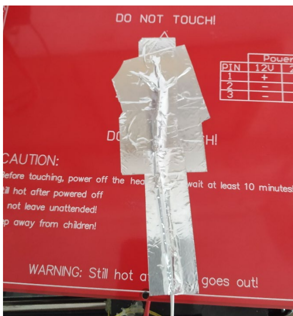
Εικόνα 61: Τοποθέτηση thermistor
