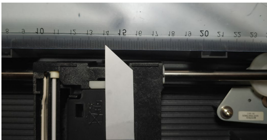
Εικόνα 52: Μέτρηση κίνησης άξονα του scanner
