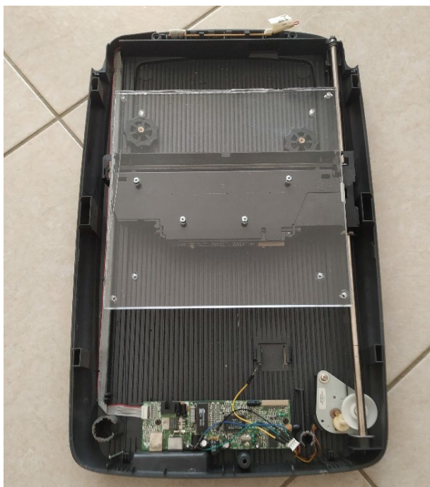
Εικόνα 60: Τοποθέτηση του Plexiglas επί της κεφαλής του scanner
