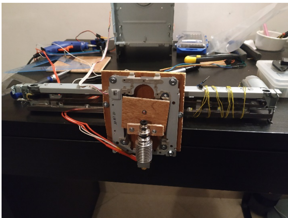
Εικόνα 58: Σύνδεση αξόνων X και Z
