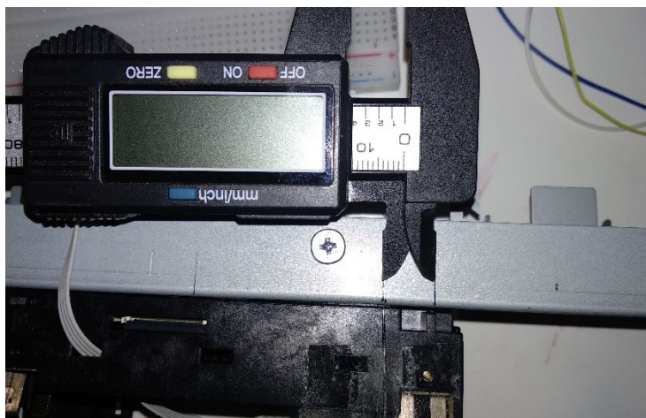
Εικόνα 56: Μέτρηση κίνησης της κεφαλής απόστασης 1cm
