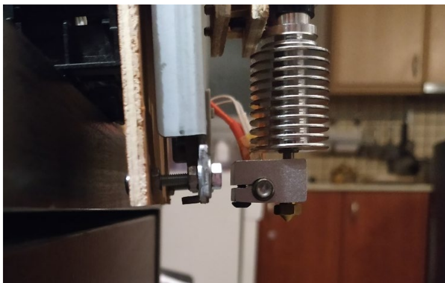
Εικόνα 59: Clearance του nozzle με τη βάση στήριξης
