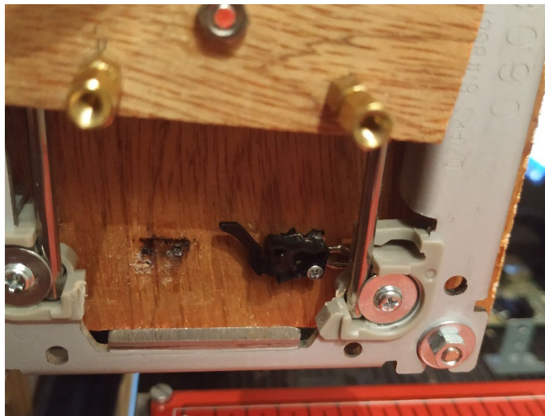
Εικόνα 68: Μηχανικός Endstop switch του άξονα Z
