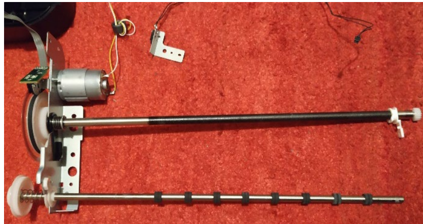
Εικόνα 33: DC motor, Optical encoder και steel rods
