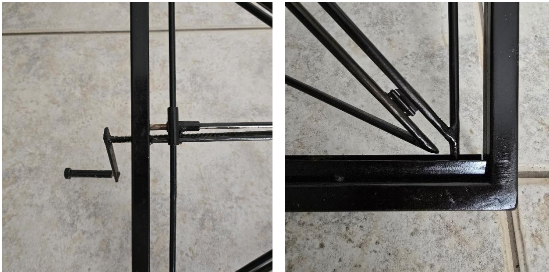
Εικόνα 76: Μηχανισμοί για μετασχηματισμό του μεταλλικού σκελετού
