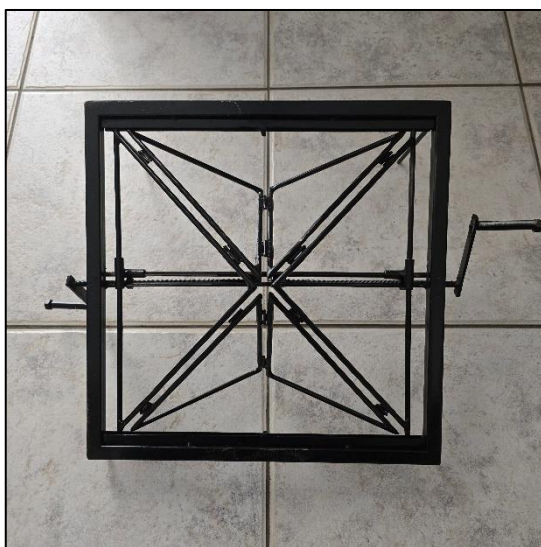
Εικόνα 79: Μεταλλικός σκελετός κατασκευής με μηχανισμό κίνησης
