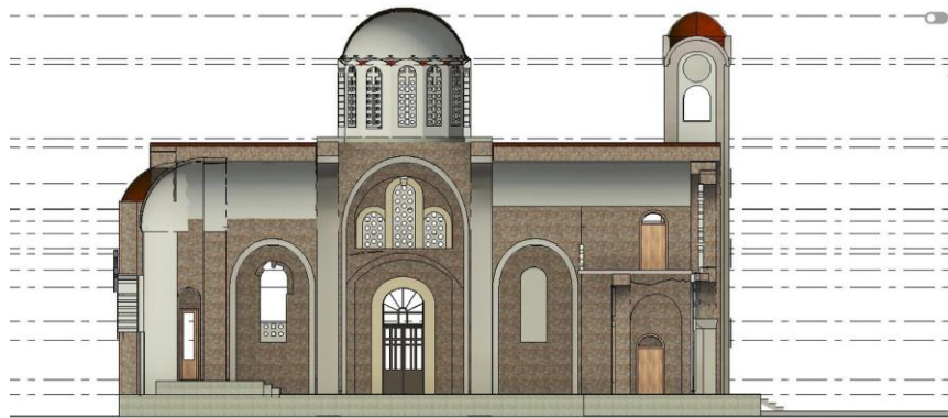
Εικόνα 3.4. Διαμήκης τομή του μοντέλου HBIM του ναού.
