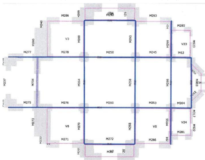
Εικόνα 4.7. Προσομοίωμα ισοδύναμου πλαισίου — επίπεδο ορόφου 1 (3Μuri).
