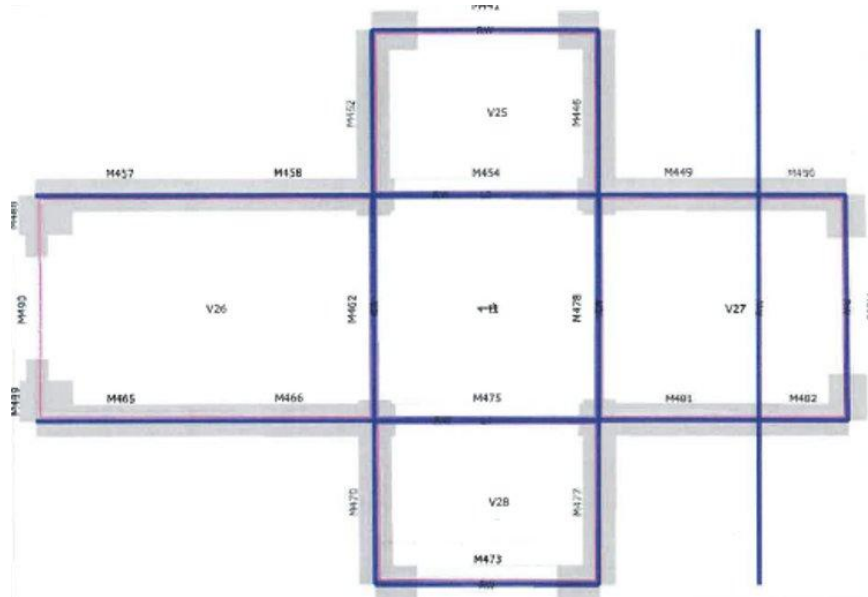
Εικόνα 4.9. Προσομοίωμα ισοδύναμου πλαισίου — επίπεδο ορόφου 2 (3Muri).
