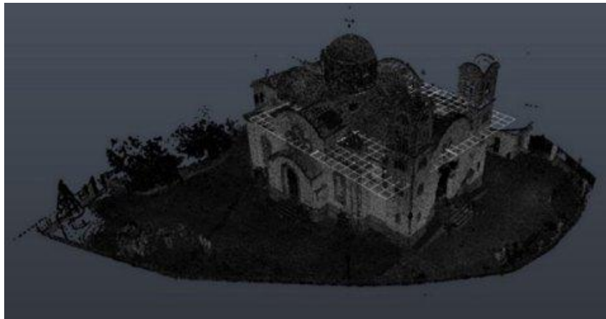
Εικόνα 4.10. Νέφος σημείων (point cloud) του ναού σε απόδοση έντασης.
