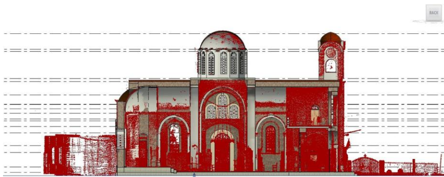
Εικόνα 3.5. Η ίδια τομή με επαλληλία του νέφους σημείων, για τον έλεγχο της αντιστοίχισης μοντέλου–point cloud.
