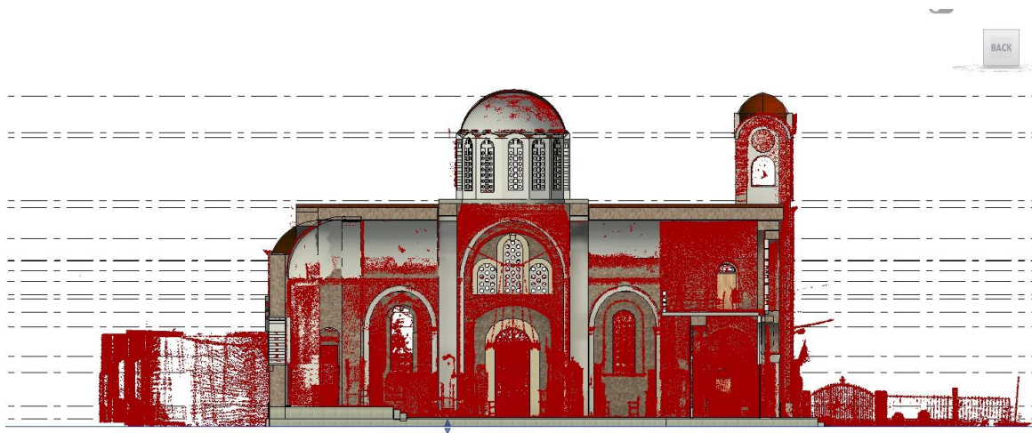
Εικόνα 5.6. Τομή αποτύπωσης ρωγμών με το νέφος σημείων (point cloud).
