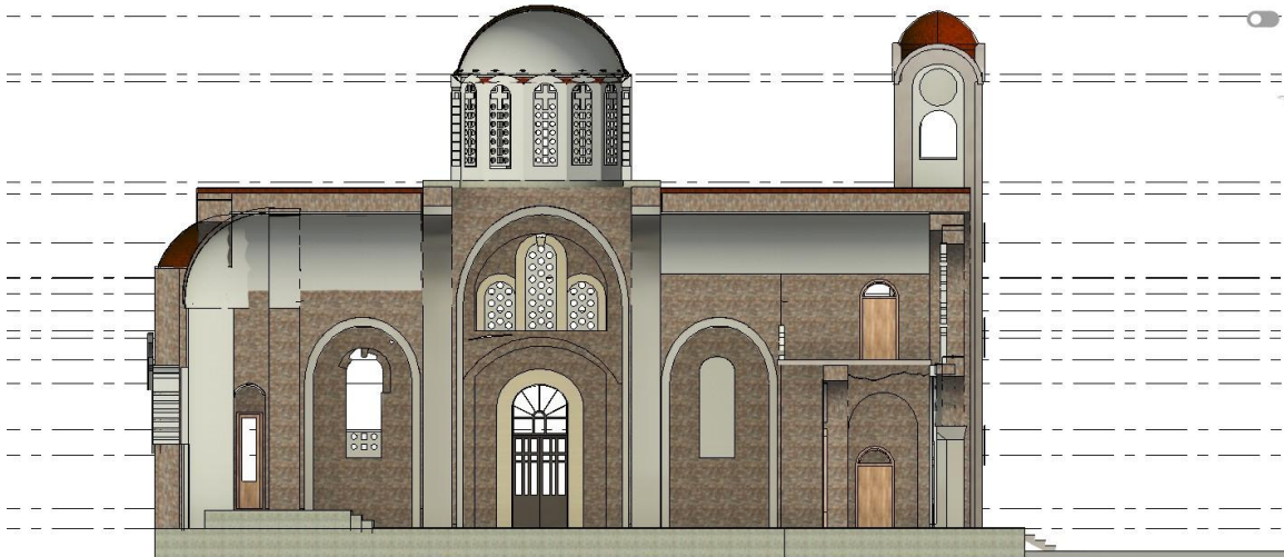
Εικόνα 5.7. Τομή αποτύπωσης ρωγμών χωρίς το νέφος σημείων (point cloud).
