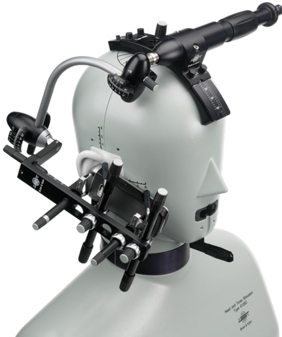
Εικ. 1-4 Μικρόφωνο κεφαλής Head and Torso Simulator (HATS) Type 4128D
