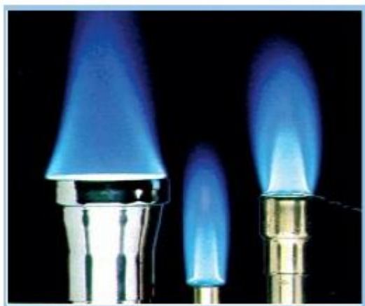
Καύση φυσικού αερίου και υγραερίου
