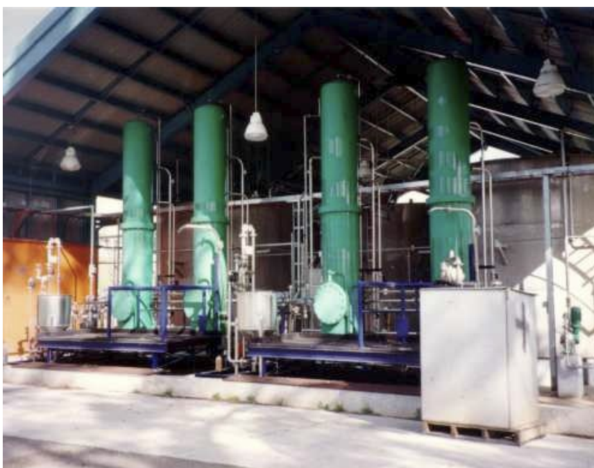
Σχήμα 35. Στήλες GAC για την επεξεργασία λυμάτων TNT.
