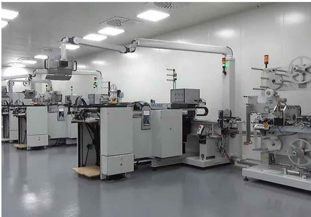
Εικόνα 16 - Μέρος μηχανής σύνθεσης καρτών. Τροφοδότες στρωμάτων πολυκαρβονικών φύλλων. (Veridos Matsoukis)
