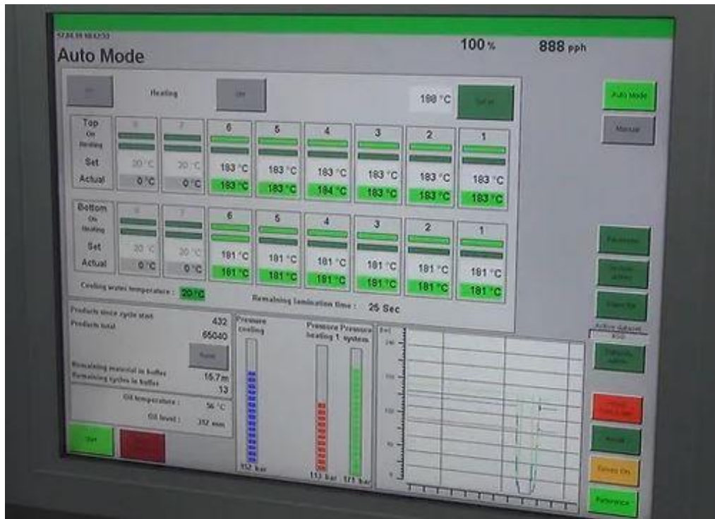
Εικόνα 17 - Οθόνη μηχανής με τις συνθήκες λαμιναρίσματος πολυκαρβονικών καρτών (Veridos Matsoukis).
