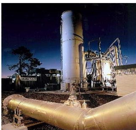
Εικόνα 14: Αριστερά: Βυθισμένος εξατμιστής στραγγίσματος. Δεξιά: Εξατμιστής τύπου συμπύκνωσης που χρησιμοποιεί θερμοκρασία χαμηλής πίεσης από (1) έξοδο αερίων μηχανής και (2) από πυρσό LFG.
