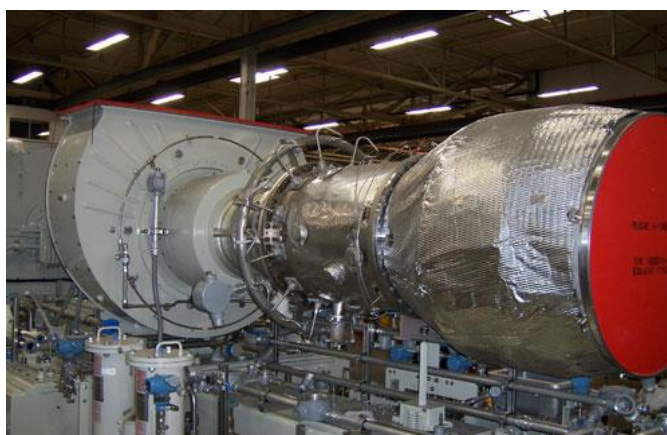
Εικόνα 12: Φωτογραφία από την εγκατάσταση τουρμπίνας LFG στο XYTA H.W Hill USA [Πηγή: http://www.klickitatpud.com/topicalMenu/about/powerResources/hwHillGasProject.aspx ]
