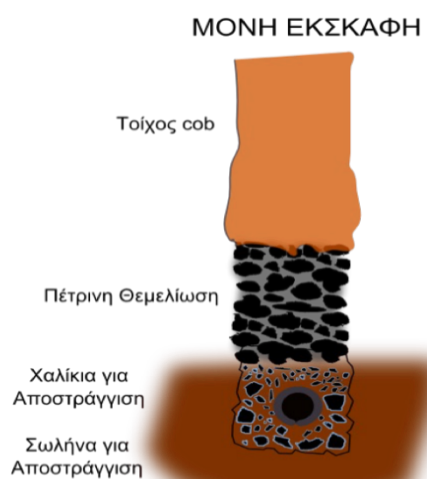
Εικόνα 5-3 : Θεμελίωση τοίχου κατασκευασμένου με τη μέθοδο του στοιβαχτού πηλού. (Πηγή: https://www.cob.gr )
