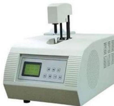
Εικόνα 2-2. Συσκευή κρυοσκοπίου.
