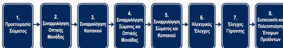
Διάγραμμα 4 Φάσεις Παραγωγικής Διαδικασίας Φωτιστικών Σωμάτων
