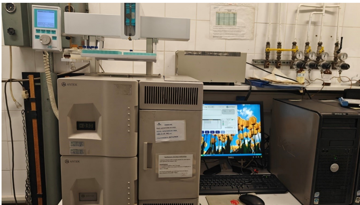
Εικόνα 2. Συσκευή μέτρησης θείου με φθορισμό υπεριώδους ακτινοβολίας.
