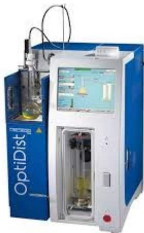
Εικόνα 4. Αυτόματη Συσκευή Απόσταξης Υγρών Καυσίμων σε Ατμοσφαιρική Πίεση.
