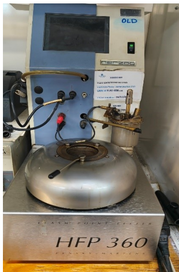
Εικόνα 3. Αυτόματη συσκευή μέτρησης σημείου ανάφλεξης
