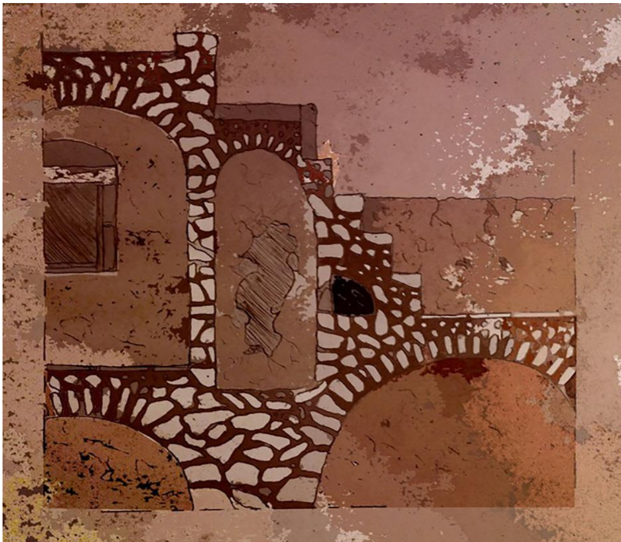
Εικόνα 60 Τομή τοιχοποιίας και θόλων κτίσματος στο Εμπορείο της Σαντορίνης, πηγή: Εμπορείο, προπτυχιακή εργασία Ε.Μ.Π., 2016
