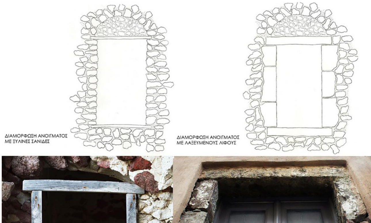
Εικόνα 61 Σκίτσα διαμόρφωσης ανοιγμάτων με ξύλινες σανίδες και με λαξευμένους λίθους, πηγή: Οία, προπτυχιακή εργασία Ε.Μ.Π., 2016
