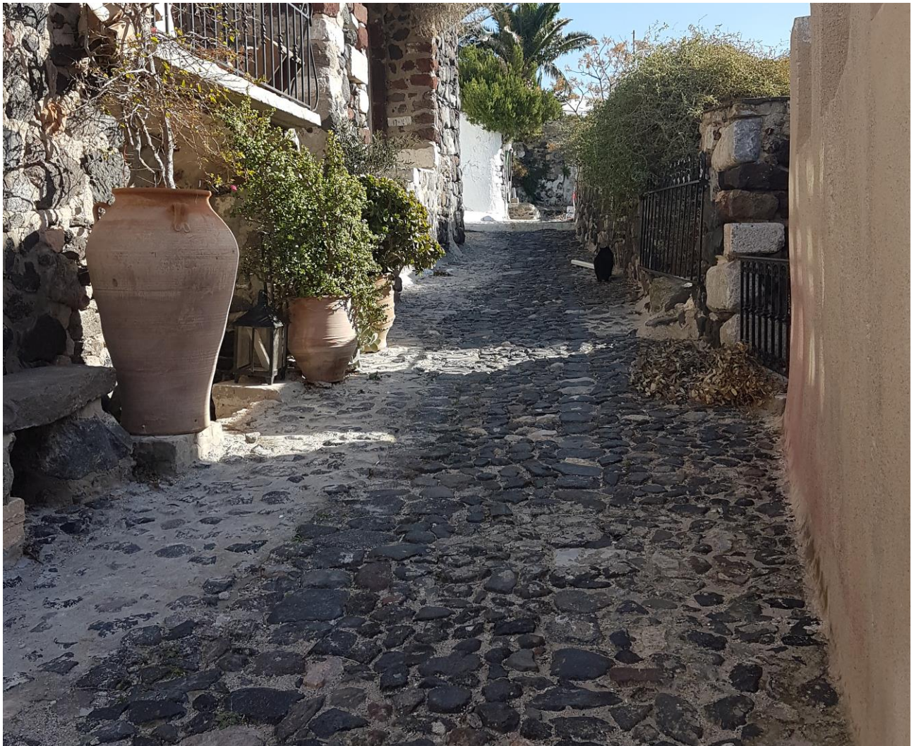
Εικόνα 63 Λιθόστρωτος δρόμος με μαυρόπετρα, με την τεχνική του πλακωτού στον Πύργο Καλλίστης, πηγή: προσωπικό αρχείο
