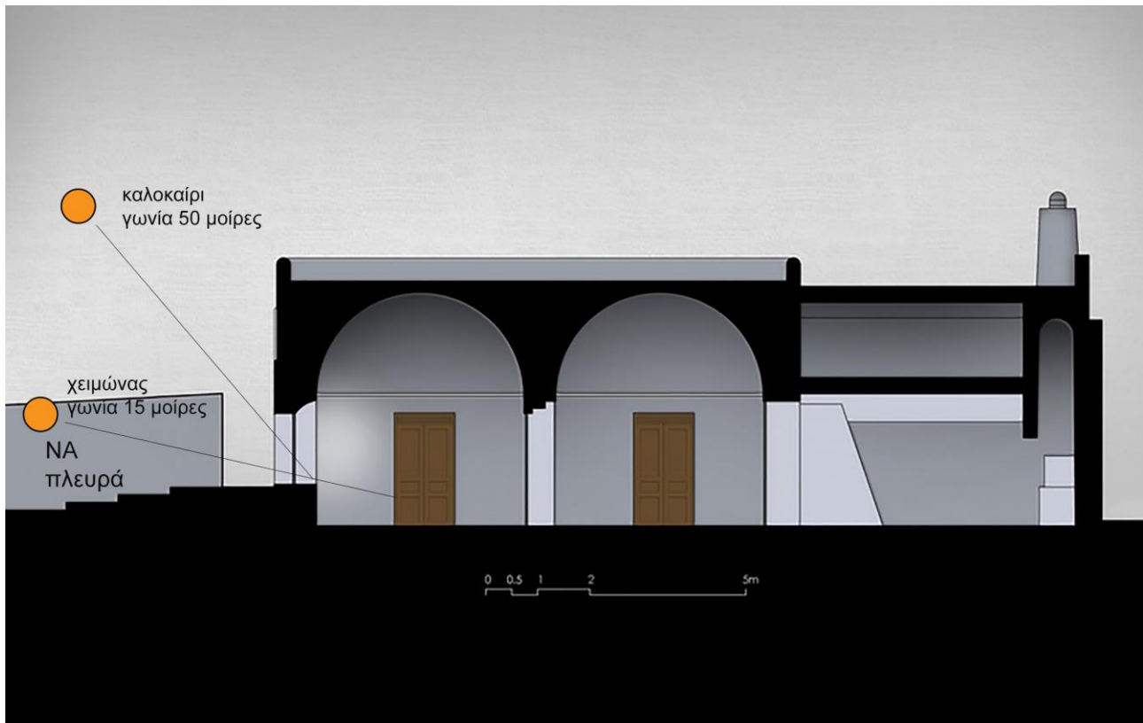
Εικόνα 85 Τομή αρχοντικού με γωνία ηλιακού ύψους (36ο Β.Γ.Π.) στις 9 το πρωί της 21ης Ιουνίου (καλοκαίρι) και της 21ης Δεκεμβρίου (χειμώνας), πηγή: ίδια επεξεργασία, υπόβαθρο: Πύργος Καλλίστης, προπτυχιακή εργασία Ε.Μ.Π., 2016
