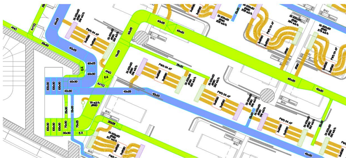
Σχέδιο 4.2: Διακλαδώσεις αεραγωγών προς τους θαλάμους νοσηλείας.
