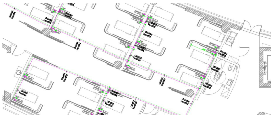
Σχέδιο 4.17: Δίκτυο ιατρικών αερίων Ζώνης 2 (Λήψεις στις καρέκλες θεραπείας).
