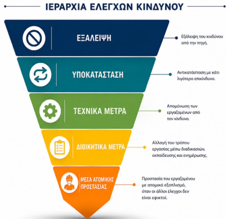
Σχήμα 2.1: Ιεραρχία ελέγχων Κινδύνων (Hierarchy of Controls) NIOSH2024
