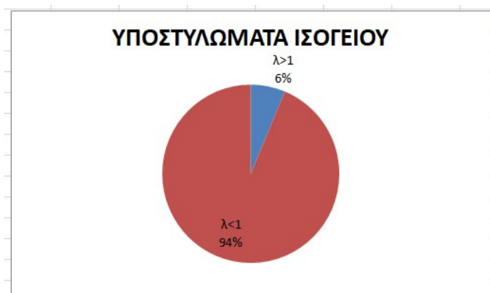
Σχήμα 7.6: Ανεπάρκειες υποστυλωμάτων ισογείου έναντι κάμψης
