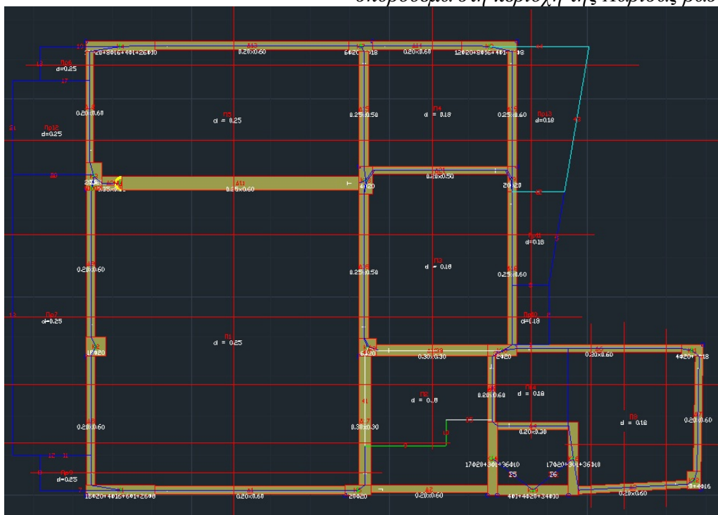
Σχήμα 4.5: Προσομοίωση του β' ορόφου στο πρόγραμμα strad 3dr
