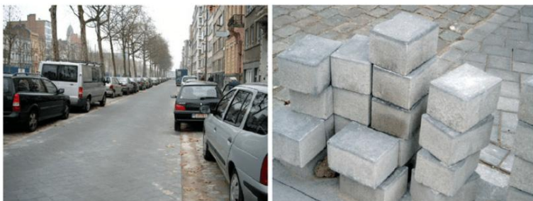
ΕΙΚΟΝΑ 5.7.: Λωρίδα στάθμευσης αυτοκινήτων στην Αμβέρσα (Βέλγιο) και φωτοκαταλυτικοί κυβόλιθοι που χρησιμοποιήθηκαν (Dudek et al., 2022)
