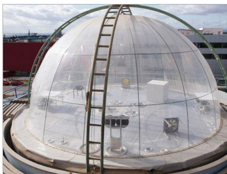
ΕΙΚΟΝΑ 5.3.: Θάλαμος EUPHORE (πηγή: http://www.ceam.es/GVAceam/ceam_en/servicios/servicios.htm )
