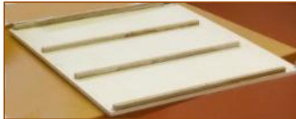
Εικόνα 3.2 Ξύλινη κατασκευή διαμορφωμένη ώστε να φιλοξενεί τα πλακίδια του σπινθηριστή.
