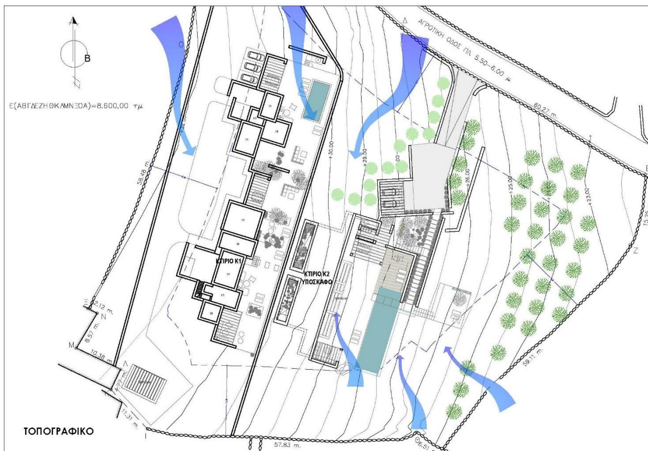
Διάγραμμα 23_ Ανεμοπροστασία & ενίσχυση αερισμού κατοικίας Γ (Πηγή: Ιδία επεξεργασία)
