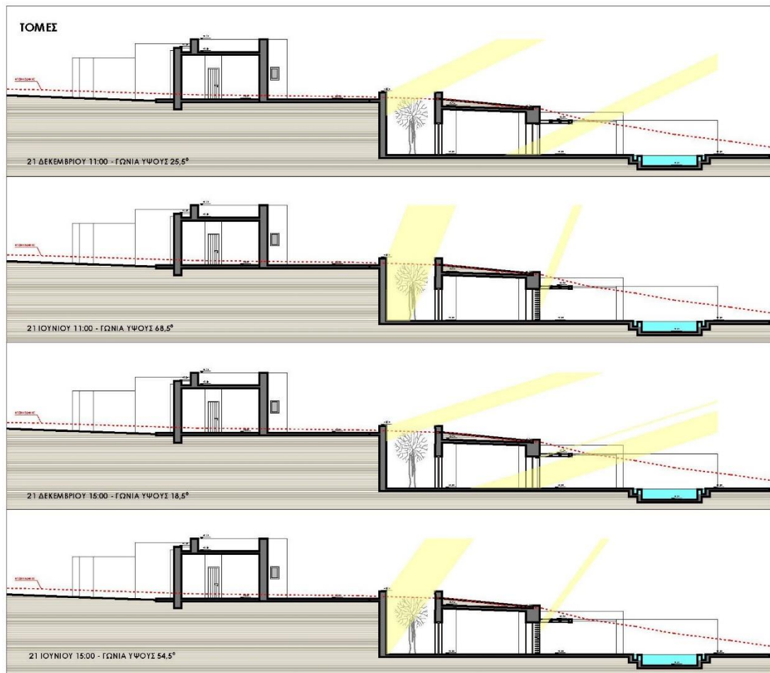
Διάγραμμα 22_ Διείσδυση ηλιακής ακτινοβολίας μετά από επεμβάσεις (Πηγή: Ιδία επεξεργασία)
