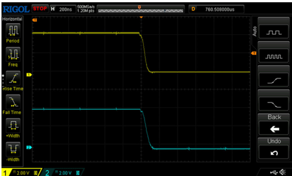
Εικόνα 23: Συγχρονισμός ακμών HSYNC και VSYNC
