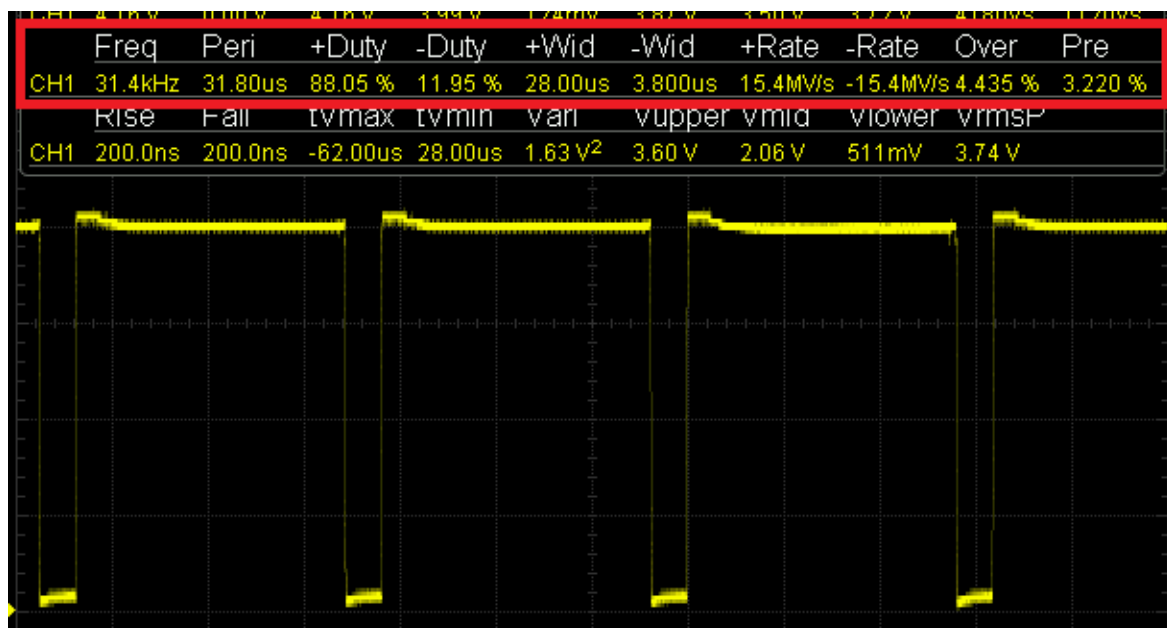
Εικόνα 19: Μικρομετρικές τιμές παλμού HSYNC
