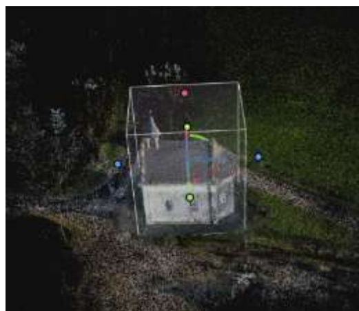
Εικόνα 61. Μείωση του μοντέλου με την εντολή Set Reconstruction Region . (Πηγή: Ιδία επεξεργασία Reality Scan )
