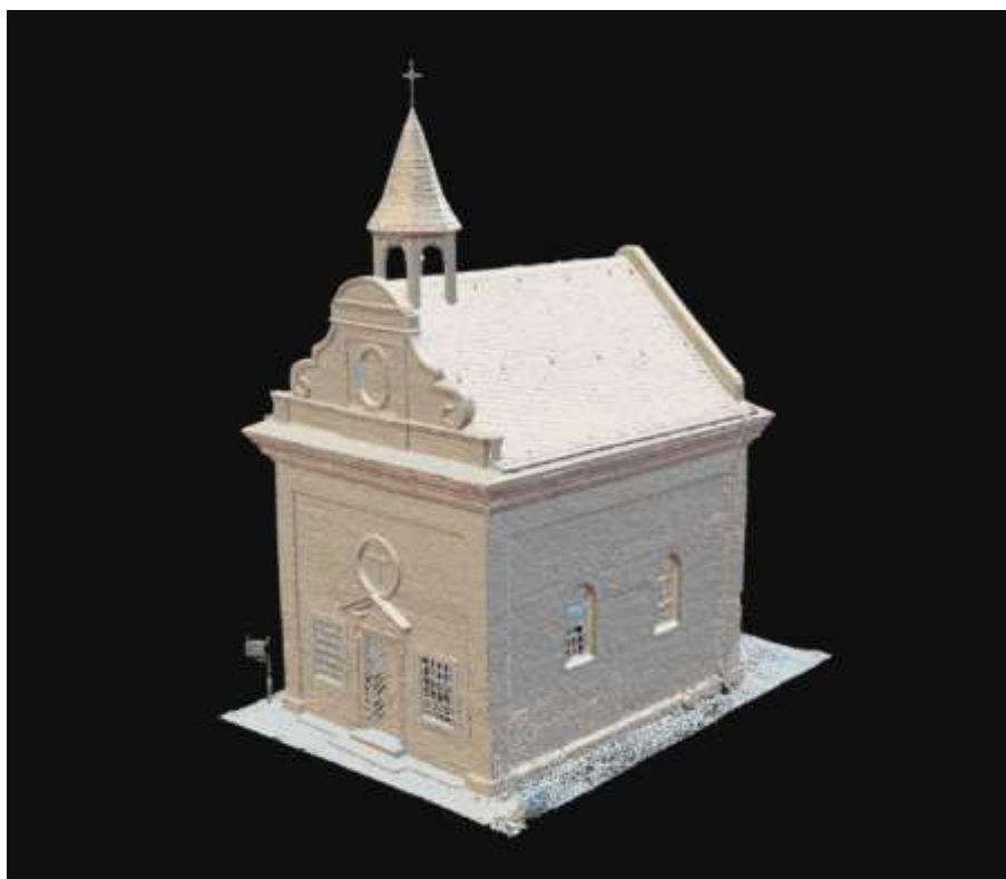
Εικόνα 63. Αρχείο Mesh φωτογραμμετρίας, πρόσοψη και νότια πλευρά. (Πηγή: Ιδία επεξεργασία Reality Scan)
