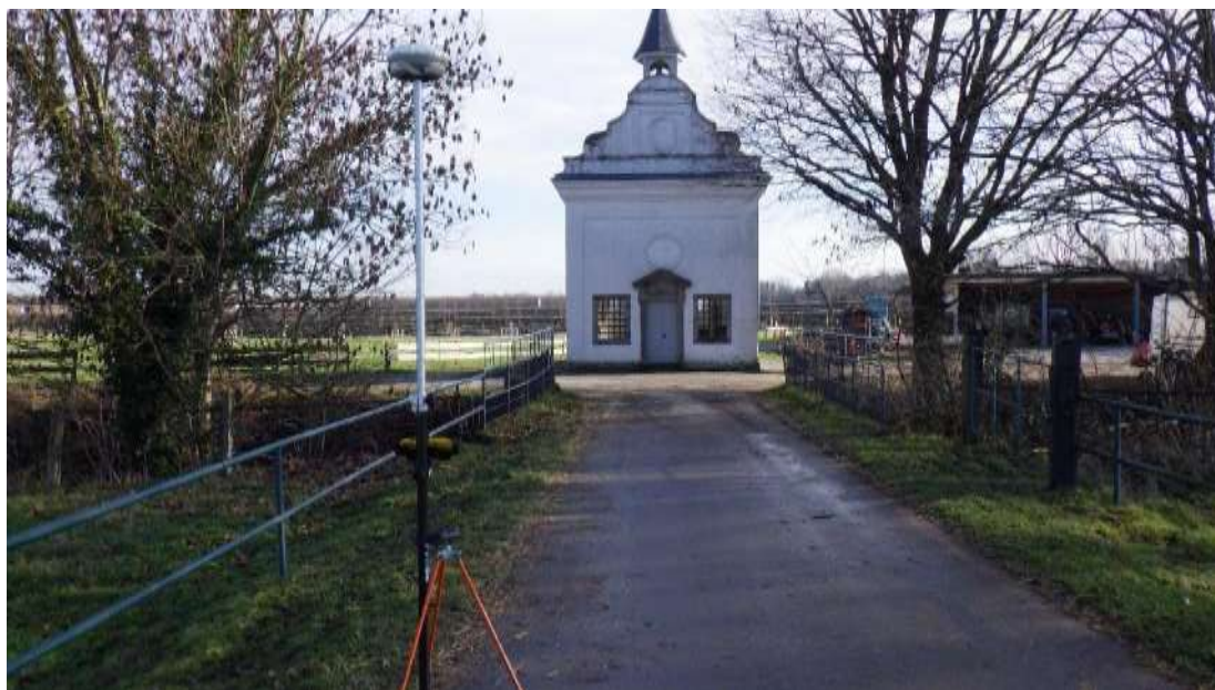
Εικόνα 33. Μέτρηση σταθερού σημείου με δέκτη GPS Trimble. (Πηγή: Φωτογραφία συγγραφέα)
