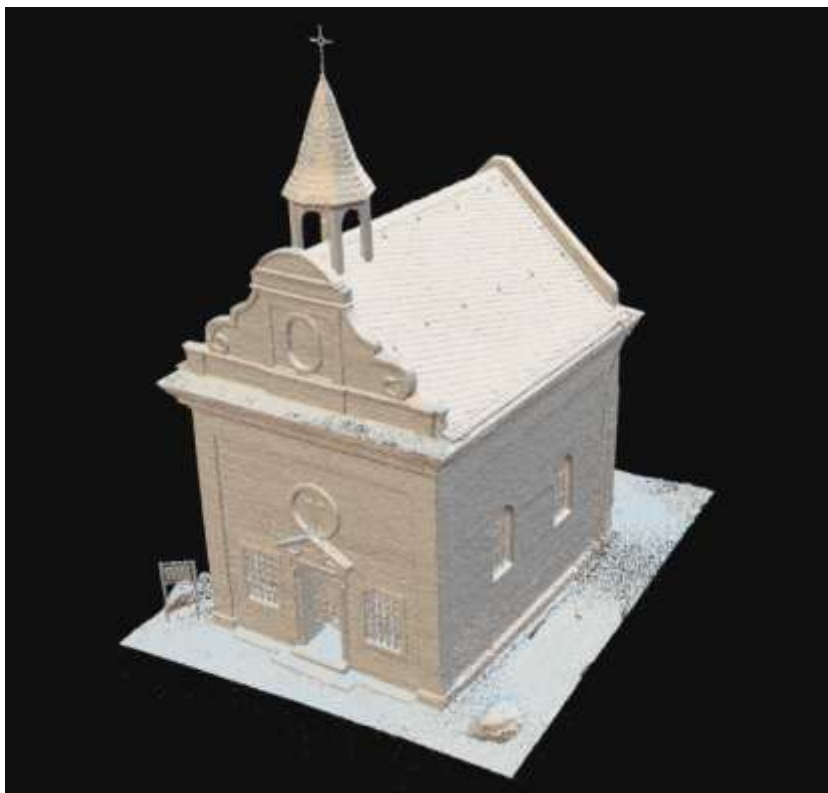
Εικόνα 65. Αρχείο Mesh φωτογραμμετρίας και σαρωτή, πρόσοψη και νότια πλευρά. (Πηγή: Ιδία επεξεργασία Reality Scan)
