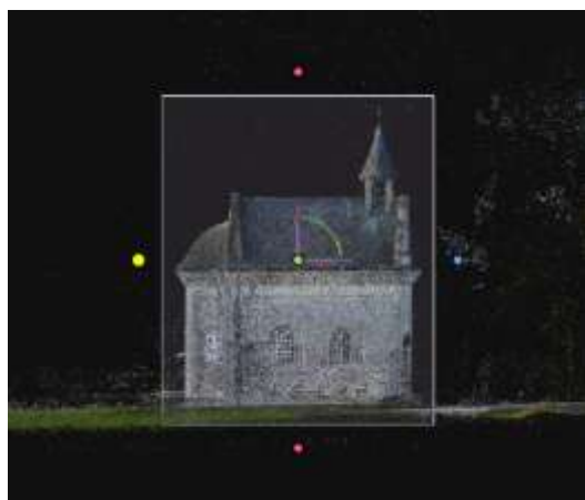
Εικόνα 61. Μείωση του μοντέλου με την εντολή Set Reconstruction Region . (Πηγή: Ιδία επεξεργασία Reality Scan )
