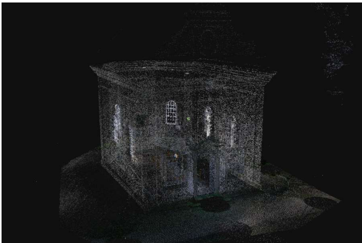
Εικόνα 60. Το ολοκληρωμένο νέφος σημείων LiDAR. (Πηγή: Ιδία επεξεργασία Reality Scan)
