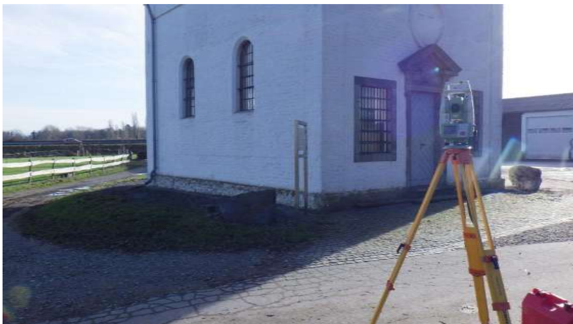
Εικόνα 34. Στάση ταχυμέτρου για την μέτρηση των σταθερών σημείων. (Πηγή: Φωτογραφία συγγραφέα)
