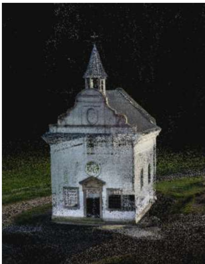
Εικόνα 53. Το αραιό νέφος σημείων από εναέριες και επίγειες εικόνες. (Πηγή: Ιδία επεξεργασία Reality Scan)
