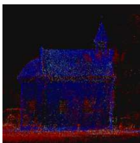
Εικόνα 56. Αξιολόγηση νέφους σημείων μέσω Point Cloud Uncertainty α) Πρόσοψη β) Κάτοψη γ) Νότια πλευρά δ) Βόρεια πλευρά. (Πηγή: Ιδία επεξεργασία Reality Scan )
