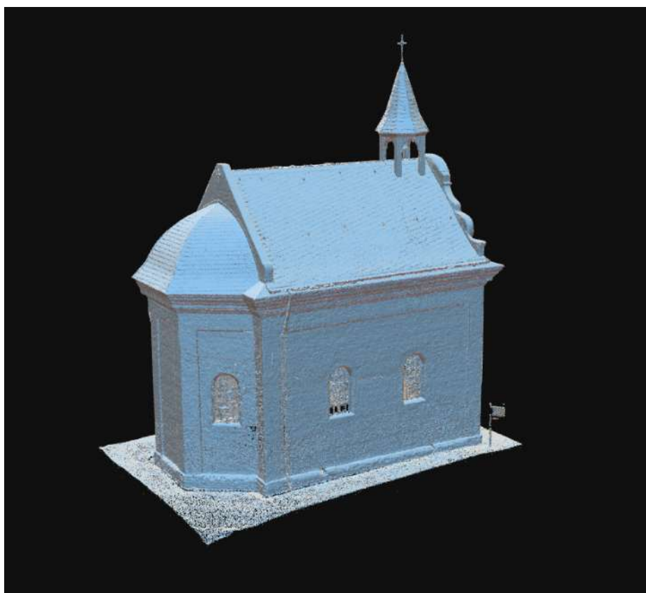
Εικόνα 64. Αρχείο Mesh φωτογραμμετρίας, δυτική και βόρεια πλευρά. (Πηγή: Ιδία επεξεργασία Reality Scan)
