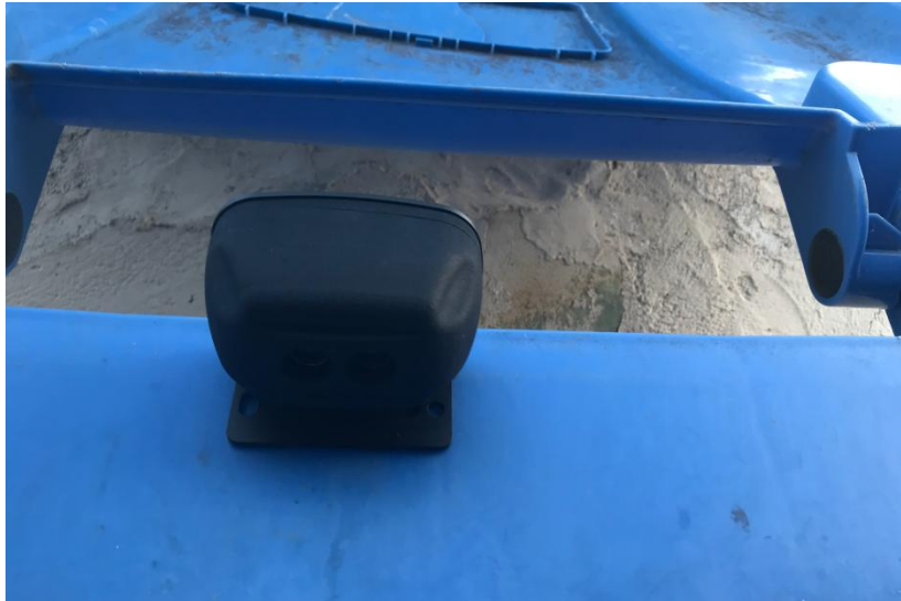
Σχήμα 22. Εγκατάσταση και απεικόνιση ορθής θέσης τοποθέτησης στο πεδίο συσκευής αισθητήρα για την μέτρηση σε πραγματικό χρόνο όγκο αστικών λυμάτων, πειραματική προσέγγιση μέτρησης όγκου αστικών λυμάτων
