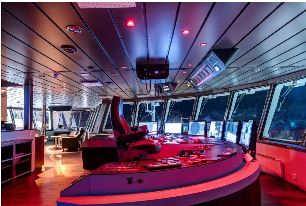
Εικόνα 4.5: Φωτισμός γέφυρας ναυσιπλοΐας με χρήση χαμηλού και ερυθρού φωτισμού
