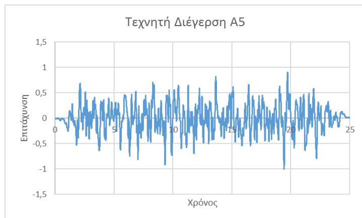
Σχήμα Δ.2: Επιταχυνσιογράφημα τεχνητής διέγερσης A5
