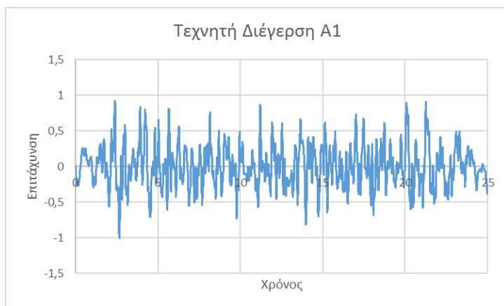
Σχήμα Δ.1: Επιταχυνσιογράφημα τεχνητής διέγερσης A1
