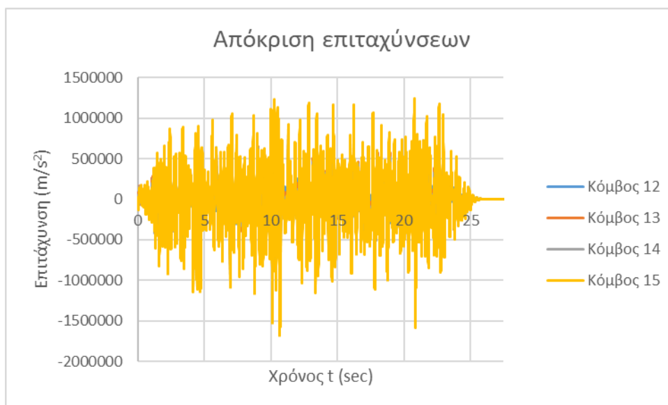
Σχήμα 6.3: Απόκριση επιταχύνσεων κόμβων για την τεχνητή διέγερση A7
