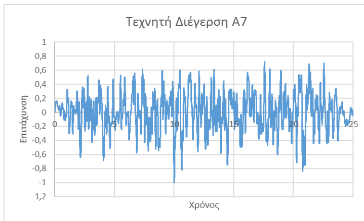
Σχήμα Δ.3: Επιταχυνσιογράφημα τεχνητής διέγερσης A7
