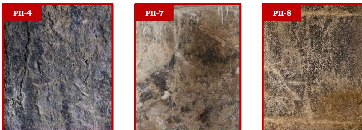
Εικόνα 17 Μαύρες κρούστες από το Ανάκτορο της Κνωσού. Σύμφωνα με τα αποτελέσματα micro-Raman, τα δείγματα περιέχουν γύψο, ενώ σε ορισμένες περιπτώσεις ανιχνεύθηκε και άμορφος άνθρακας (Kalokairinou, 2018).
