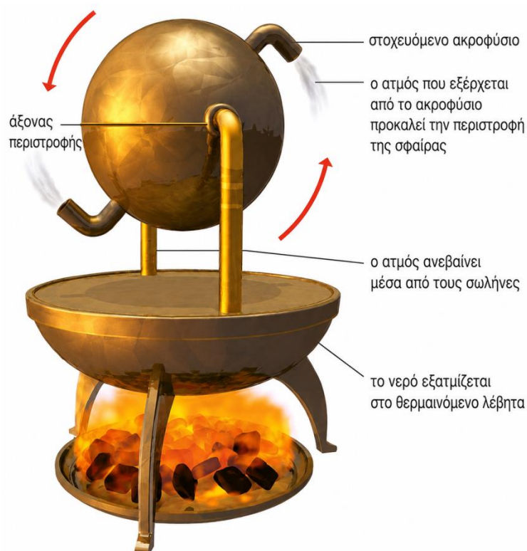
Εικόνα 3.8: Η αιολόσφαιρα του Ήρωνα, όπου η εκτόνωση ατμού προκαλεί περιστροφική κίνηση.
