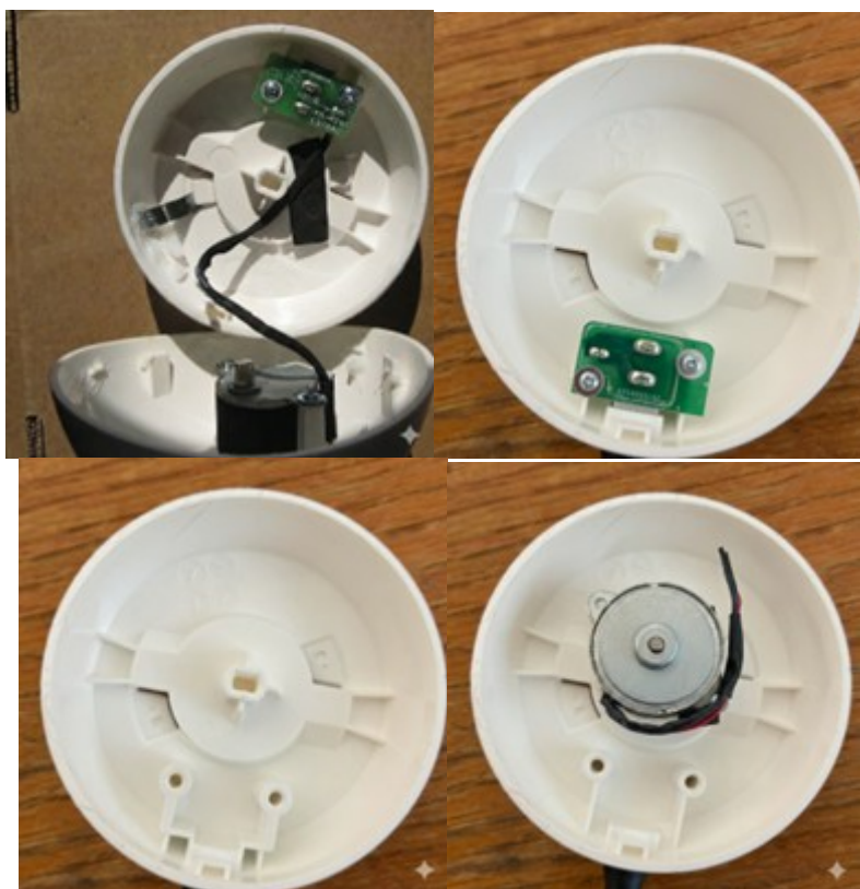
Εικόνα 17 - Αποσυναρμολόγηση βάσης και τοποθέτηση κινητήρα
