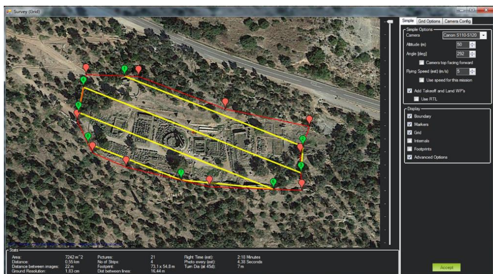
Εικ. 28. Λογισμικό Σταθμού Ελέγχου Εδάφους (GCS). Μενού αυτοματοποιημένης εναέριας έρευνας: οι κόκκινες κουκκίδες και οι κόκκινες γραμμές υποδεικνύουν την έκταση της περιοχής που θα καλυφθεί, οι κίτρινες γραμμές είναι οι γραμμές πτήσης και οι πράσινες κουκκίδες είναι τα σημεία στροφής του UAS.
