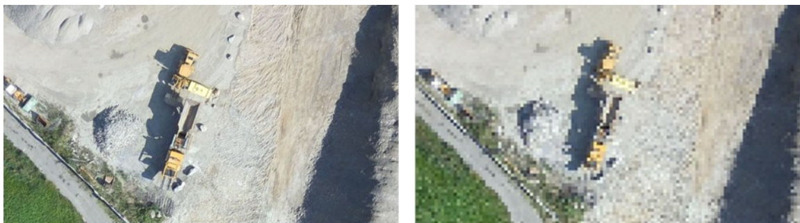
Εικ. 30. Ακόμα κι αν το drone πετάει οριζόντια, η λεπτομέρεια (GSD) των εικόνων μπορεί να αλλάζει. Αυτό συμβαίνει επειδή το έδαφος έχει ανωμαλίες και η κάμερα αλλάζει ελαφρώς γωνία. Εφόσον ο χάρτης (ορθομωσαϊκό) συνδυάζει τις θέσεις της κάμερας και ένα τρισδιάστατο μοντέλο εδάφους, το λογισμικό υπολογίζει και χρησιμοποιεί μια μέση τιμή ανάλυσης για όλο το έργο. Πηγή: Ground sampling distance (GSD) in photogrammetry, https://support.pix4d.com/hc/en-us/articles/202559809 (5/6/2026).
