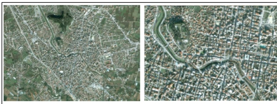
Εικ. 13. Παράδειγμα μικρής 1:20.000 (αριστερά) και μεγάλης 1:1.000 (δεξιά) κλίμακας αεροφωτογραφίας.
