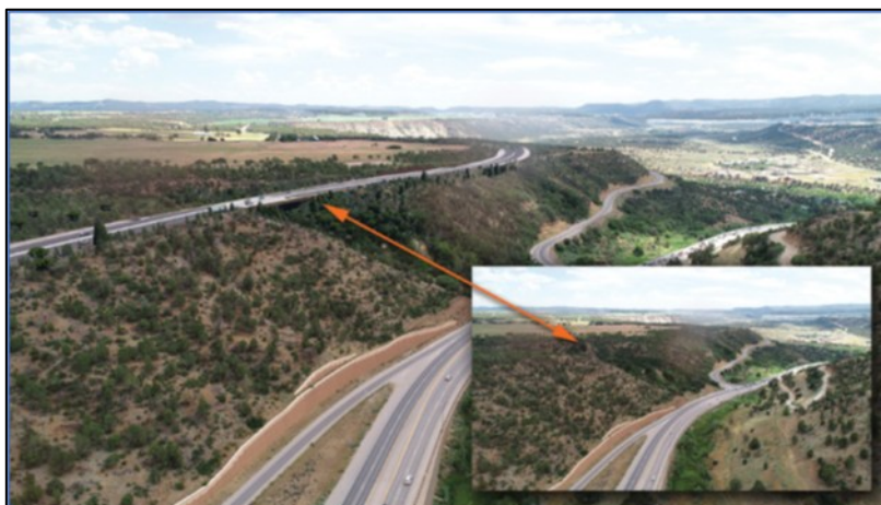
Εικ. 9. Η υπάρχουσα φωτογραφία από drone (μικρή στα δεξιά) επικαλύπτεται με ένα τρισδιάστατο μοντέλο δημιουργώντας αυτήν την απλή αλλά αποτελεσματική φωτογραφική αντιστοίχιση του νέου δρόμου. Πηγή: Tal & Altschuld, 2021, σ. 29.
