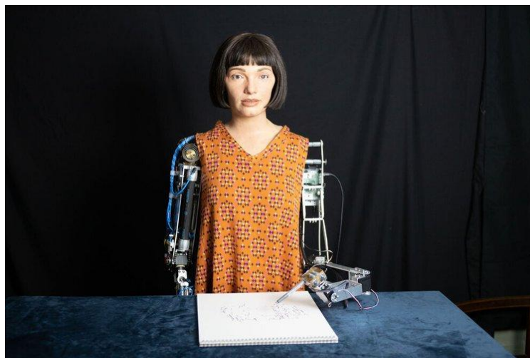
Εικόνα 1. Το ρομποτικό σύστημα Ai-Da κατά τη διαδικασία σχεδιασμού στον φυσικό χώρο με τη χρήση υπολογιστικής όρασης και μηχανικού βραχίονα
