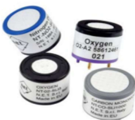
Εικόνα 7. Ενδεικτική απεικόνιση ηλεκτροχημικών αισθητήρων αέριων ρύπων. Ενδεικτικές ηλεκτροχημικές κυψέλες αισθητήρων για την ανίχνευση τοξικών αερίων και την παρακολούθηση της συγκέντρωσης οξυγόνου. Στην επάνω δεξιά θέση διακρίνεται ο γαλβανικός αισθητήρας οξυγόνου O 2 -A2 της Alphasense. Πηγή: Alphasense (2024).
