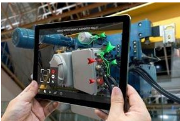
Εικόνα 3.10: Εφαρμογή AR με επικάλυψη αντικειμένων και συγκεκριμένα με την επαύξηση ψηφιακών γραφικών σε μηχανή στο χώρο της βιομηχανίας (Πηγή: Arrow, 2026)
