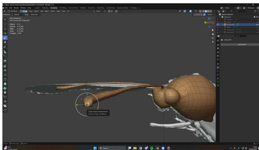
Εικόνα 4.25: Άποψη του ολοκληρωμένου κεφαλιού και της κεραίας. Επεξεργασία του τελευταίου face ώστε να αντιστοιχεί στη σωστή θέση με αυτή του οδηγού- high poly μοντέλου που βρίσκεται από κάτω.
