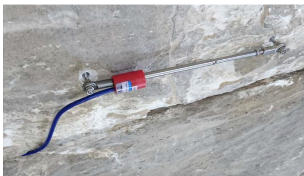
Εικ.19. Ρωγμόμετρο τύπου παλλόμενης χορδής (crackmeter 4420-1532066) εγκατεστημένο κάθετα στη ρωγμή της εσωτερικής πλευράς μίας εκ των μαρμάρινων λιθοπλίνθων της οροφής
