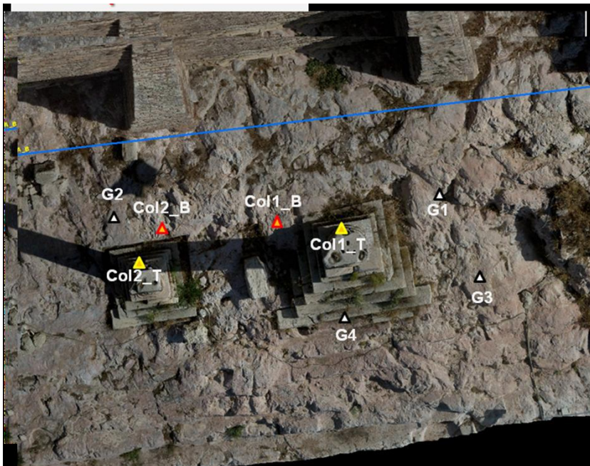
Εικ.26. Θέσεις των 8 από τους 9 αισθητήρων στην περιοχή των χορηγικών κίωνων της Νότιας Κλιτύος. Ο 9 ος τοποθετήθηκε πιο μακριά πάνω στο σχιστολιθικό βράχο.
