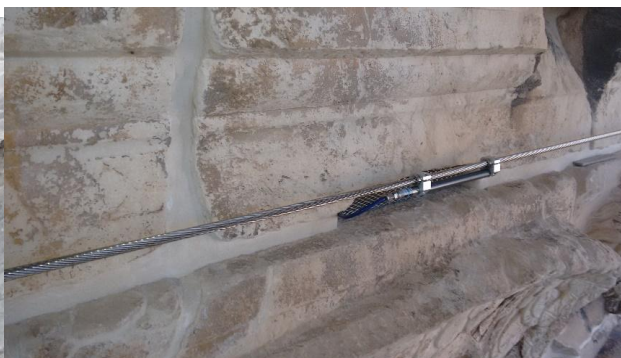
Εικ.20. Μηνυνσιόμετρο τύπου παλλόμενης χορδής εγκατεστημένο στον περιμετρικό περιδετήρα
