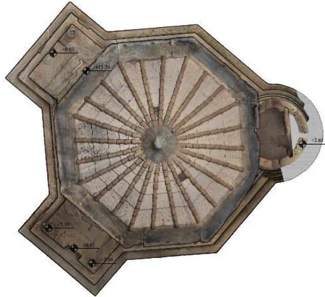
Εικ.16. Κάτοψη της μαρμάρινης στέγης του Ωρολογίου Κυρρήστου. πηγή: (25)
