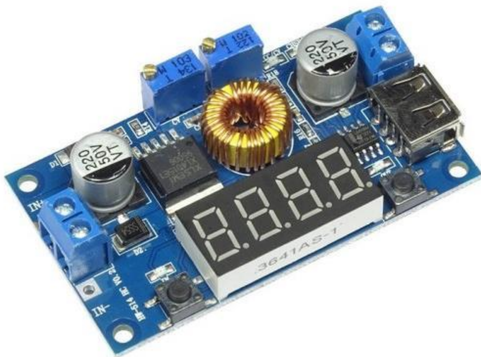
Εικόνα 4-4 DC-DC Step Down Converter τύπου XL4015
