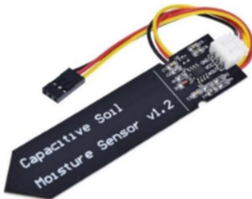
Εικόνα 1-12 Χωρητικός Αισθητήρας Υγρασίας (capacitive soil moisture sensor)
