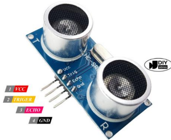
Εικόνα 1-13 Αισθητήρας Υπερηχητικός (ultrasonic sensor) HC-SR04
