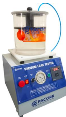
Εικόνα 33. Σύστημα ανίχνευσης διαρροών κενού
