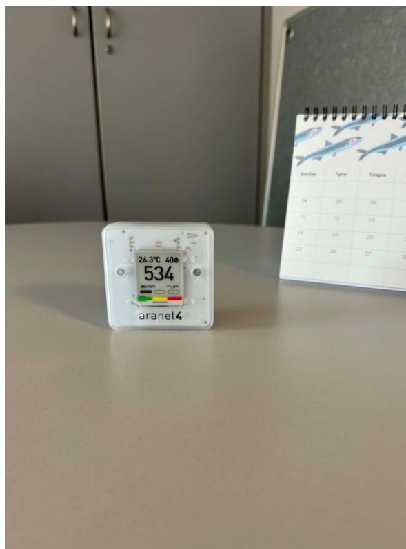
Εικόνα 5. Όργανο μέτρησης ποιότητας αέρα Aranet4.
