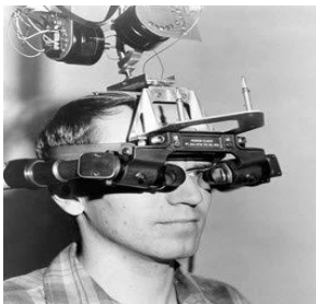
Εικόνα 2. «Δαμόκλειος Σπάθη». Πρώιμη συσκευή που αναπτύχθηκε από τον Ivan Sutherland στο Πανεπιστήμιο της Utah, 1970
