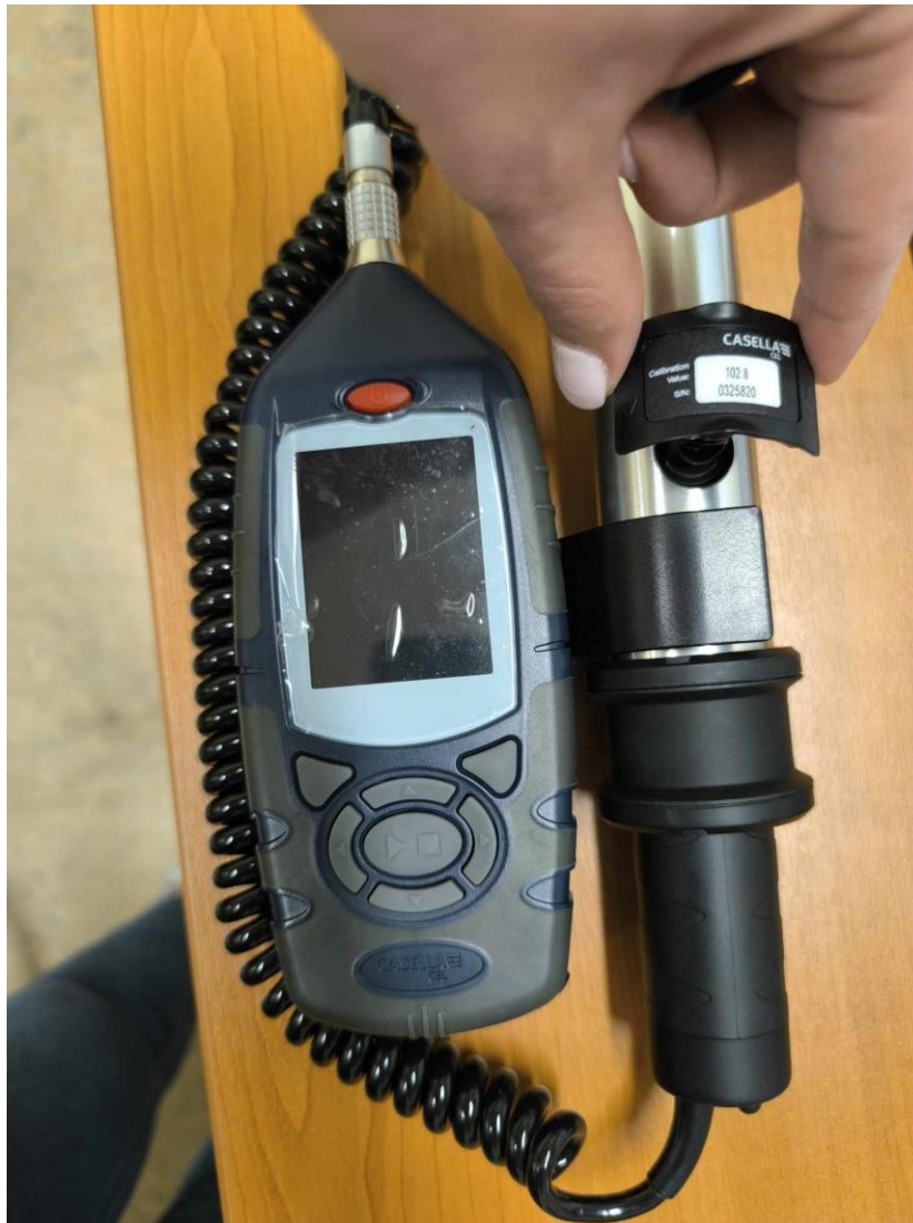
Εικόνα 38: Τοποθέτηση εξαρτήματος βαθμονόμησης
