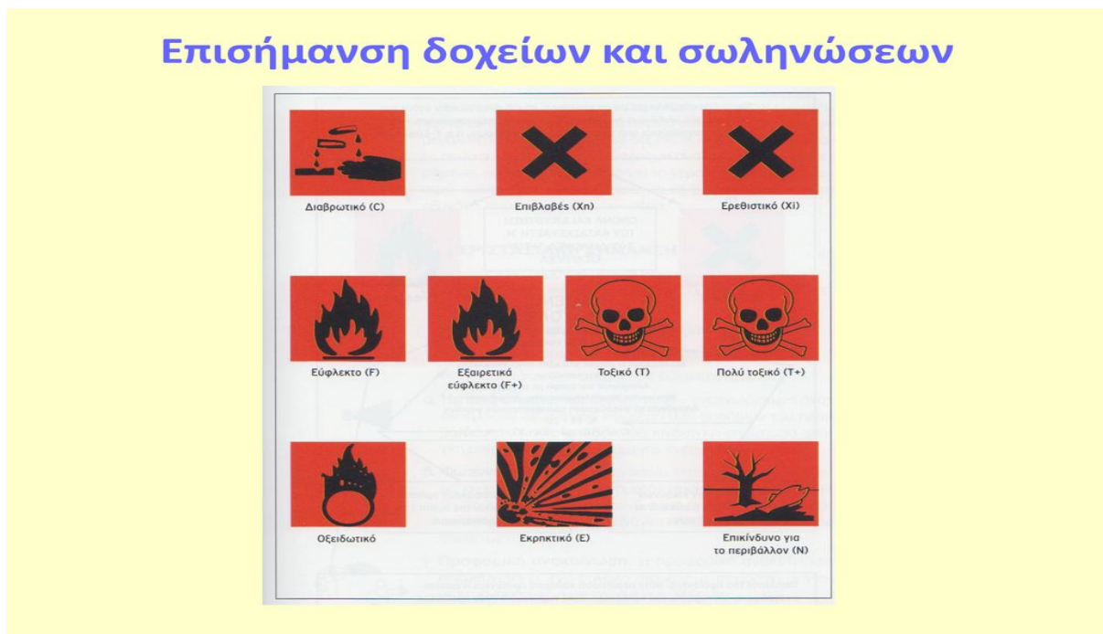
Εικόνα 5: Σήμανση δοχείων και σωληνώσεων
