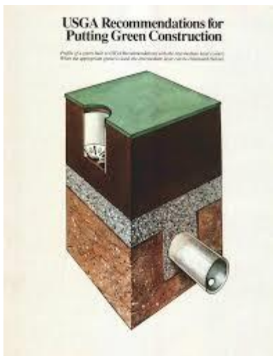
Εικόνα 13. Τομή στη οποία φαίνεται η προδιαγραφή κατασκευής του συστήματος αποστράγγισης του green κατά USGA.
