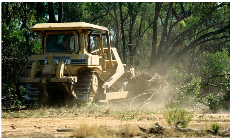
Εικόνα 11. Προωθητής γαιών κατά την εργασία καθαρισμού ψηλής βλάστησης.
