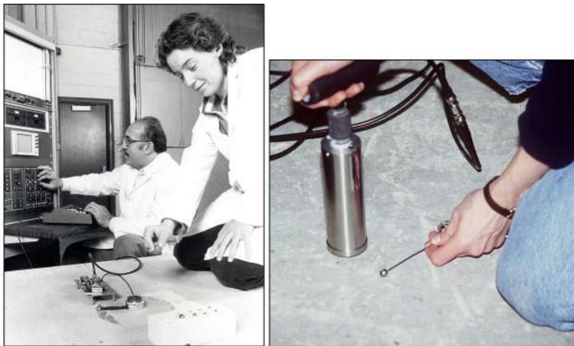
Εικόνα 18: (Αριστερά) Στις πρώτες έρευνες χρησιμοποιήθηκαν χαλύβδινες σφαίρες για να επιτευχθούν κρούσεις με διαφορετικούς χρόνους επαφής. (Δεξιά) Η χαλύβδινη σφαίρα προσαρμόστηκε σε χαλύβδινη ράβδο ώστε να είναι κατάλληλη για δοκιμές πεδίου [50]
