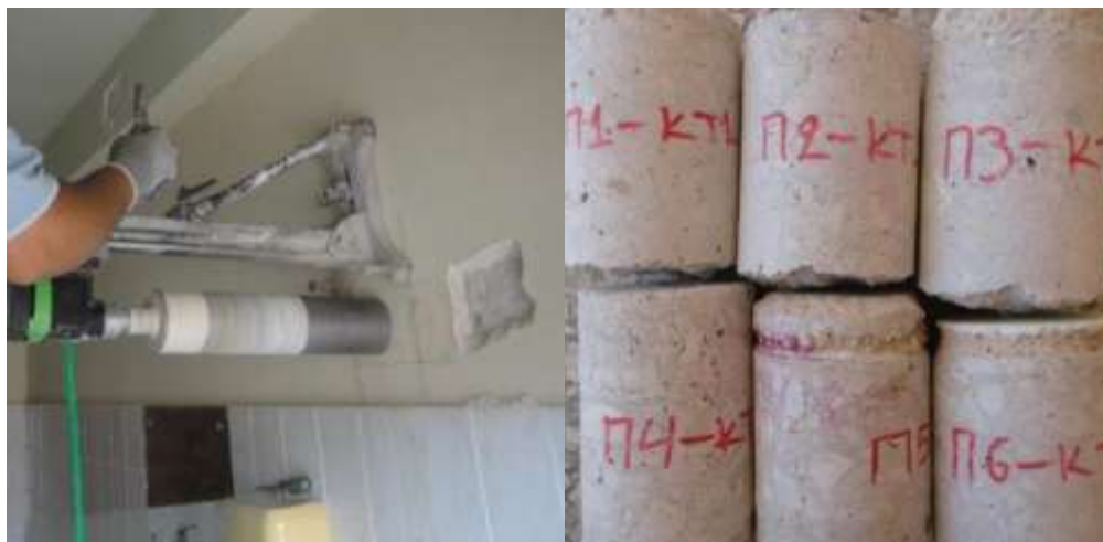
Εικόνα 40: Καροτιέρα και εξαχθέντες πυρήνες
