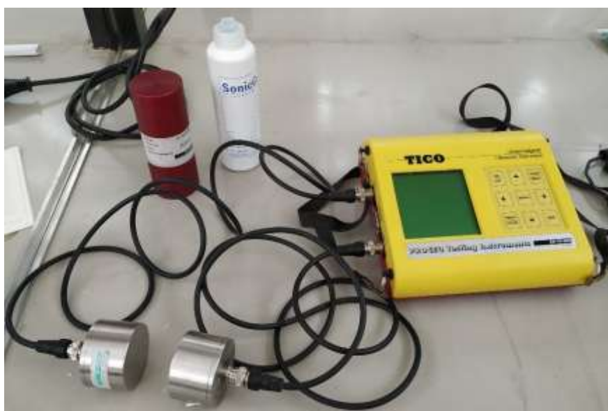
Εικόνα 11: Συσκευή UPV, TICO, ράβδος βαθμονόμησης και λιπαντική ουσία
