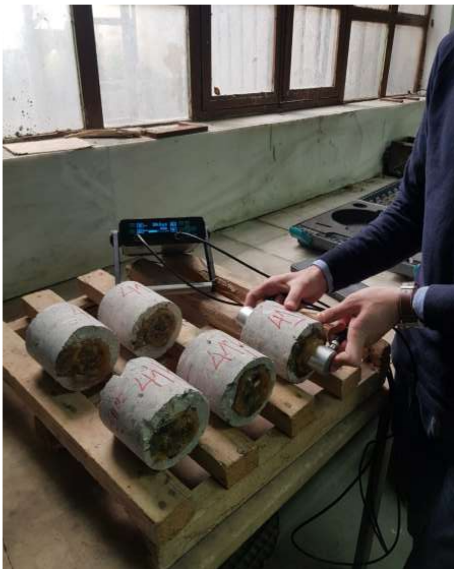
Εικόνα 42: Διεξαγωγή μέτρησης επί δοκιμίου σκυροδέματος με τη χρήση της μεθόδου UPV
