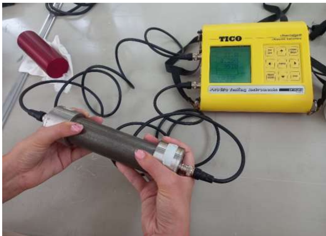
Εικόνα 36: Δοκιμή UPV σε δοκίμιο χάλυβα (με μη κατάλληλους αισθητήρες)
