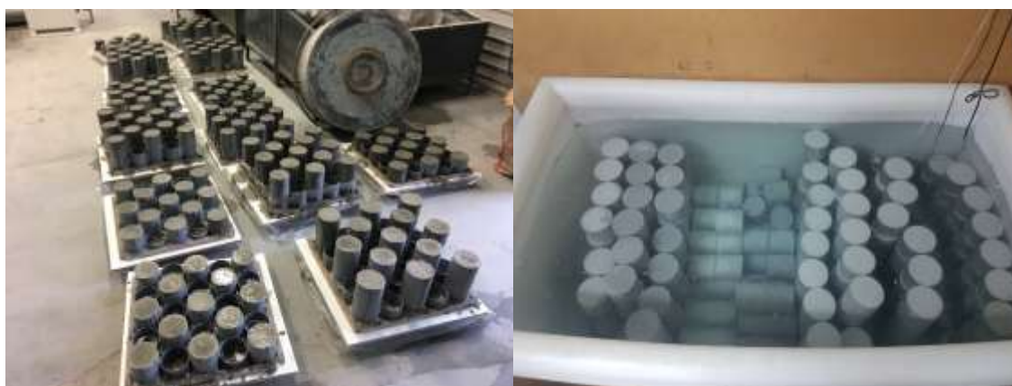
Εικόνα 100: Αριστερά – Παρασκευή και Δεξιά – Ωρίμανση δοκιμών σκυροδέματος
