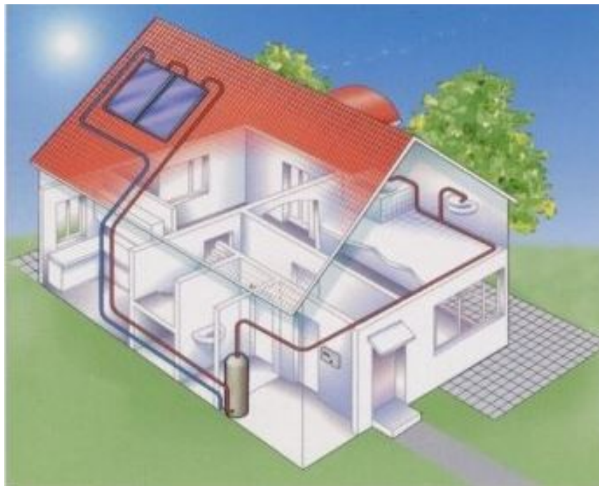
Εικόνα 6: Λειτουργία Ηλιακού Θερμοσίφωνα.
