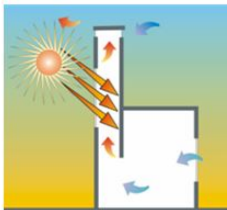
Εικόνα 16: Σχηματική απεικόνιση λειτουργίας ηλιακής καμινάδας.
