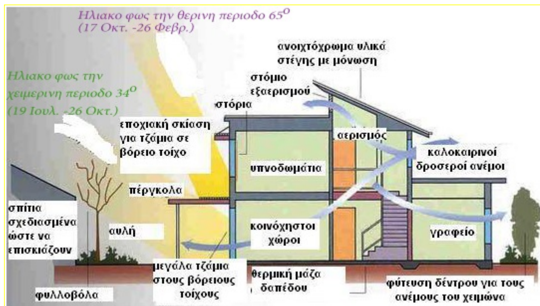
Εικόνα 7: Απεικόνιση παραδείγματος λειτουργίας βιοκλιματικού κτιρίου.
