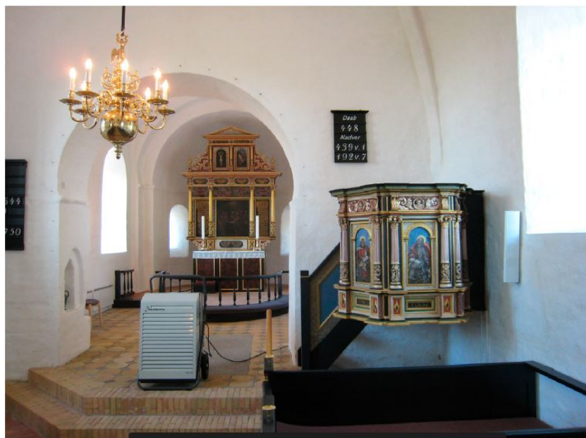
Εικόνα 31: Αφυγραντήρας συμπύκνωσης στο εσωτερικό εκκλησίας ο οποίος απομακρύνεται κατά τη διάρκεια της λειτουργίας.
