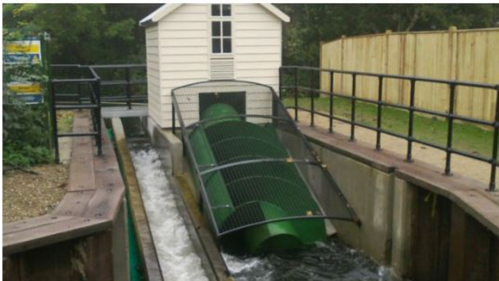
Εικόνα 29: Χρήση κοχλιωτή αντλία θετικής εκτόπισης.
