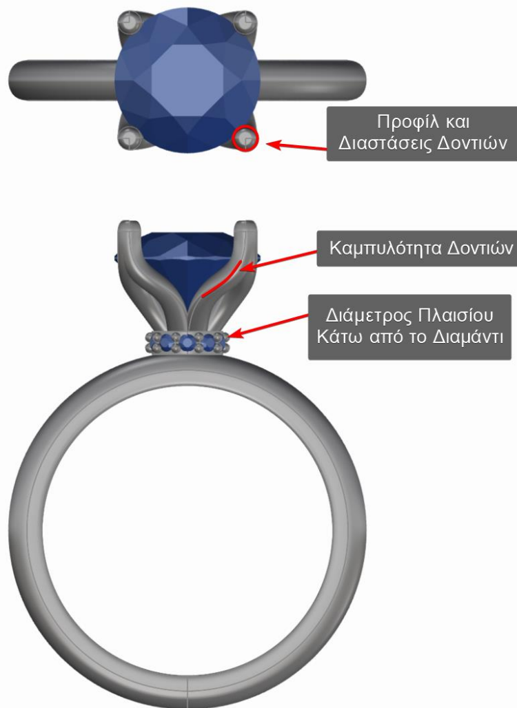
Εικόνα 3.4 - Βασικές λεπτομέρειες που παραμετροποιήθηκαν για το δαχτυλίδι Tulip
