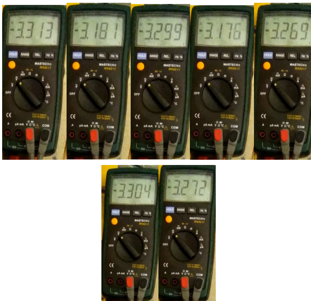
Εικόνα 40. Εναλλαγές τάσης τροφοδοσίας ανά 0.5 sec περίπου
