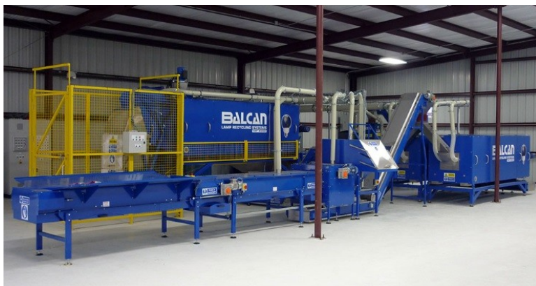
Εικόνα 21: Μηχάνημα διαχωρισμού γυαλιού και αλουμινίου (ΟΙΚΟΚΥΚΛΙΟΣ Α.Ε., 2024) Στην εικόνα (No.22) παρουσιάζεται σύστημα φιλτραρίσματος εκπομπών υδραργύρου.
