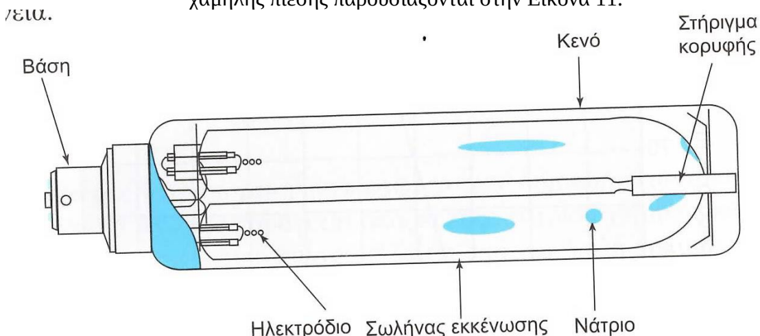
Εικόνα 11: Δομή λαμπτήρα ατμών νατρίου χαμηλής πίεσης (ΒΟΛΕΛΗΣ & ΦΩΚΟΣ, 2017)
